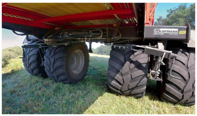
Die «Super Large»-Pendelachse kann in Hanglagen ausgefahren werden, so dass die Aufstandsbreite um 60cm auf bis zu 314cm erhöht werden kann. Bilder: R. Burkhalter
