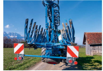
Für Sicherheit bei der Strassenfahrt sorgt dieser Heckabschluss mit Beleuchtung.
