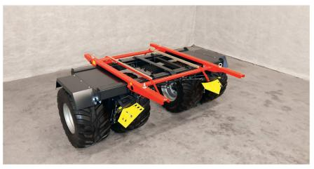
Die Achse im Detail: Beim Ein- und Ausfahren der Pendeleinheiten werden die Stahlprofile durch Gleitelemente aus Hartkunststoff geführt.
