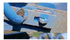
Verbaut werden Pflugkörper vom Typ «DuraMaxx», die nicht verschraubt sind und einfach in den Rumpf eingesteckt werden können.
