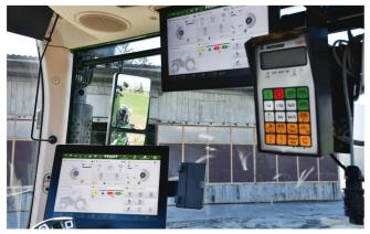
Mit einem Isobus-tauglichen Anbaugerät ist kein Fremd-Terminal mehr notwendig. Das Dach-Terminal übernimmt dessen Aufgaben.
