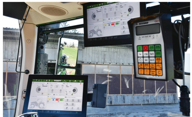
Mit einem Isobus-tauglichen Anbaugerät ist kein Fremd-Terminal mehr notwendig. Das Dach-Terminal übernimmt dessen Aufgaben.
