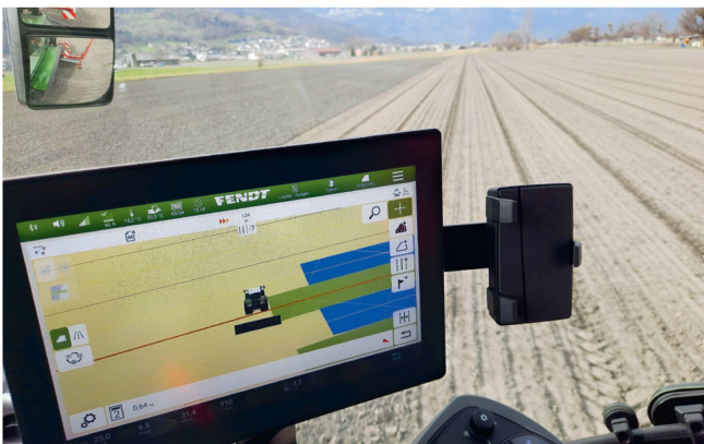
Das 12-Zoll-Terminal auf der Armlehne. Im Basispaket ist die Vorbereitung zur Spurführung vorhanden. Bilder: U. Giger und R. Hunger
