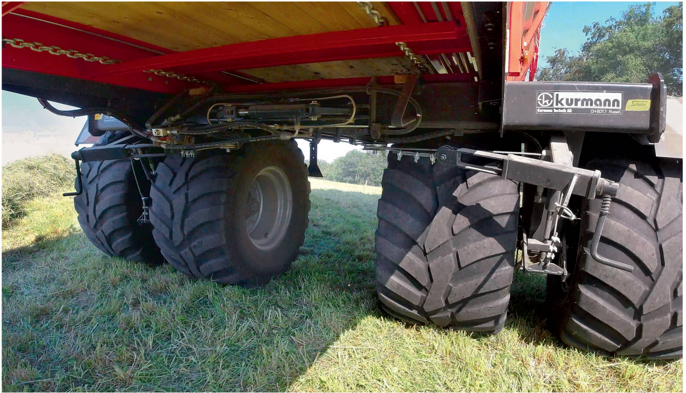
Die «Super Large»-Pendelachse kann in Hanglagen ausgefahren werden, so dass die Aufstandsweite um 60 cm auf bis zu 314 cm erhöht werden kann. Bilder: R. Burkhalter
