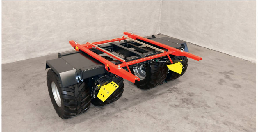
Die Achse im Detail: Beim Ein- und Ausfahren der Pendeleinheiten werden die Stahlprofile durch Gleitelemente aus Hartkunststoff geführt.
