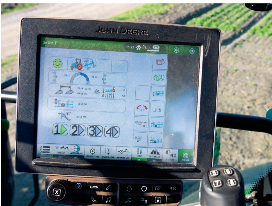
Die Pflugsteuerung erfolgt direkt über ein Isobus-kompatibles Terminal.
