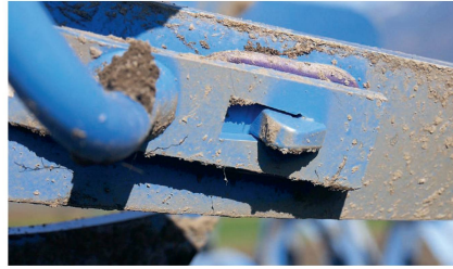
Verbaut werden Pflugkörper vom Typ «DuraMaxx», die nicht verschraubt sind und einfach in den Rumpf eingesteckt werden können.
