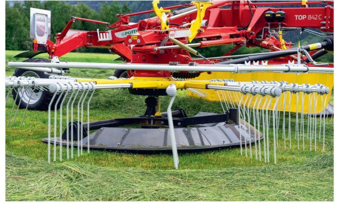
Bei korrekter Einstellung und richtiger Drehzahl halten sich die Bröckelverluste beim Schwader in Grenzen. Bild: Pöttinger
