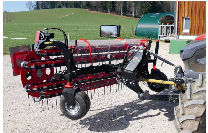
Der zapfwellenbetriebene Kammchwader wiegt nur 350 kg und wird mit einem Pendelbock an den Traktor angebaut. Ein Windschutz verhindert das Überwerfen des Heus. Die Stütze mit Rad vorne (im Bild links) ist zum Abstellen und schnellen Umplatzieren.
