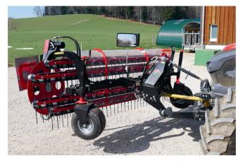
Der zapfwellenbetriebene Kammschwader wiegt nur 350 kg und wird mit einem Pendelbock nahe an den Traktor angebaut. Ein Windschutz verhindert das Überwerfen des Heus. Die Stütze mit Rad vorne (im Bild links) ist zum Abstellen und schnellen Umplatzieren.
