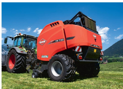
Die Kuhn «VB 7160 OC» presste die härtesten Ballen, brauchte dafür aber viel Energie.
