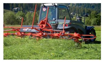
Kreiselheuer fördern durch intensive Bearbeitung das Abtrocknen und reduzieren indirekt die Atmungsverluste.
