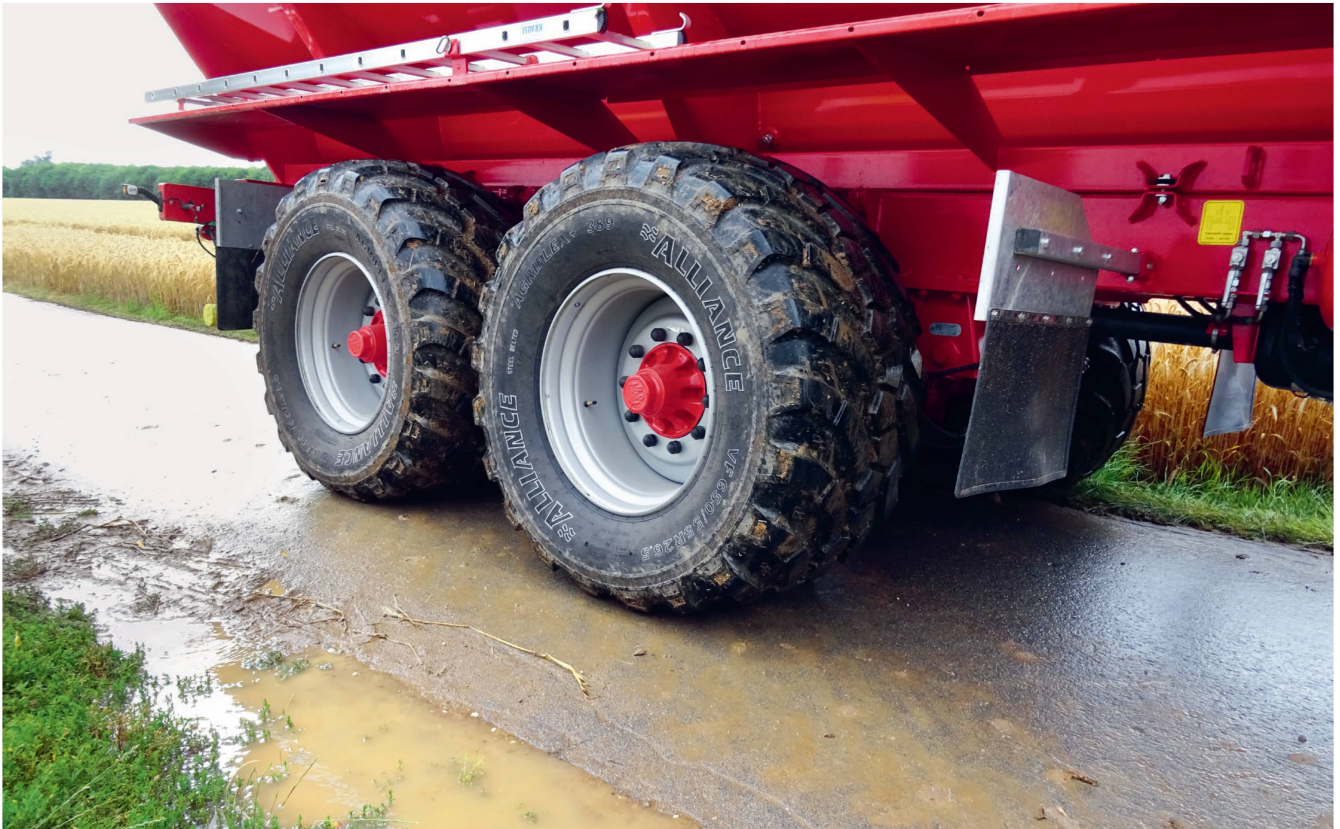
Viele Tandemachs-Aggregate, die in landwirtschaftlichen Anhängern verbaut werden, erreichen bei Starkbremsungen auf der Strasse nicht die notwendige Abbremsung. Bild: R. Engeler
