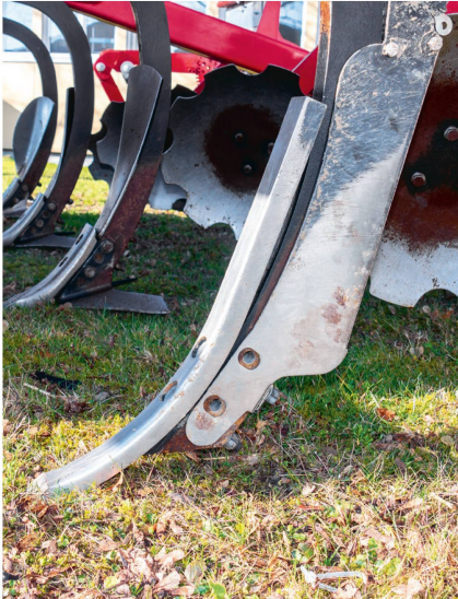
Blick auf die Zinken mit der Bestückung eines «MulchMix»- (hinten) und eines «Low-Disturbance»-Schars (vorne).
