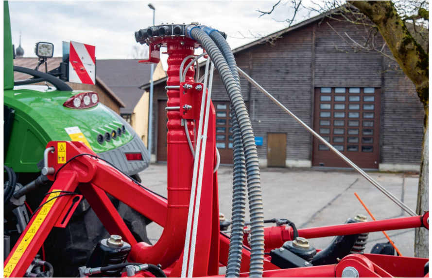
Der Verteilkopf für den Dünger mit je zwei Ausgängen zu jedem Zinken. Diese Ausrüstung kann auch für die Ablage einer Zwischensaat verwendet werden.
