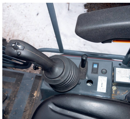
Die Funktionen am Joystick lassen sich feinfühlig dosieren.
