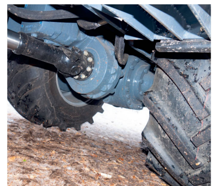
Der Antrieb wird über Verteilergetriebe und Gelenkwellen auf die Achsen verteilt.
