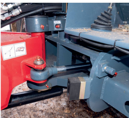
Gelenkt wird über ein robust gebautes Knick-Pendelgelenk.
