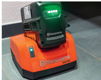
Der rund 2 kg schwere «BLi 300»-Akku ist mit Ladegerät «QC 330» in rund 80 Minuten wieder aufgeladen.
