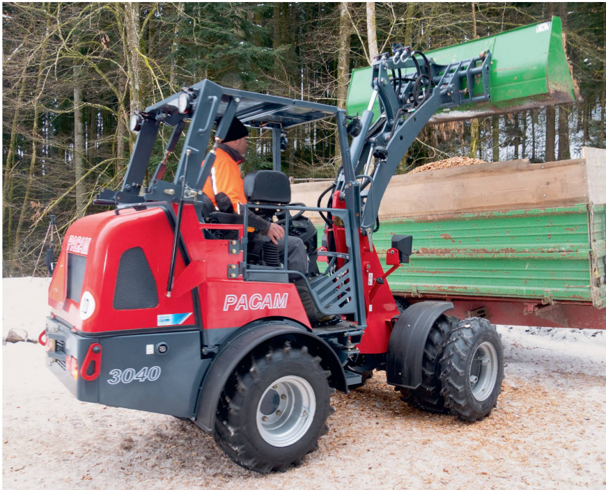
Der Pacam «3040» mit 40-PS-Motor, Doppelbereifung und klappbarem Fahrerschutzdach stand der «Schweizer Landtechnik» in einem dreiwöchigen Praxistest zur Verfügung.
