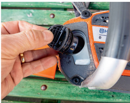
Verlustsichere Muttern und der klappbare Deckel (Bild) sind angenehme Features, sind aber heute eigentlich Standard.
