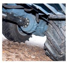
Der Antrieb wird über Verteilergetriebe und Gelenkwellen auf die Achsen verteilt.
