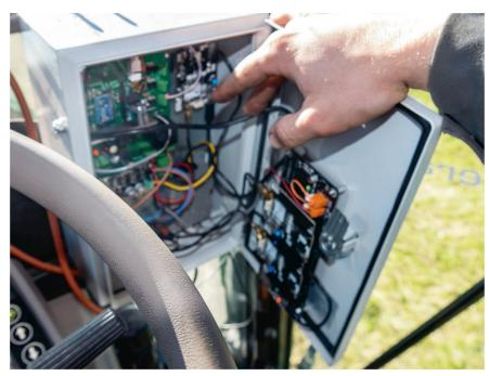
Steuerungskasten mit selbst gelöteter Leiterplatte und den GPS-Empfängern.
