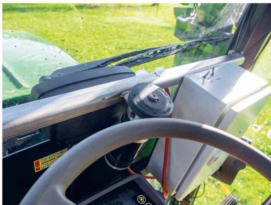
Der Lenkradmotor wurde unterhalb der Frontscheibe in der Kabine platziert.
