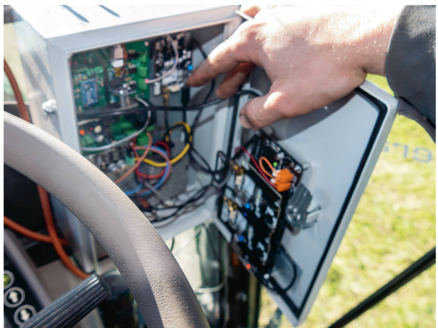
Steuerungskasten mit selbst gelöteter Leiterplatte und den GPS-Empfängern.
