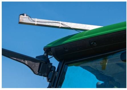
Die Antenne auf dem Traktor für den Empfang der Satelliten-Signale.
