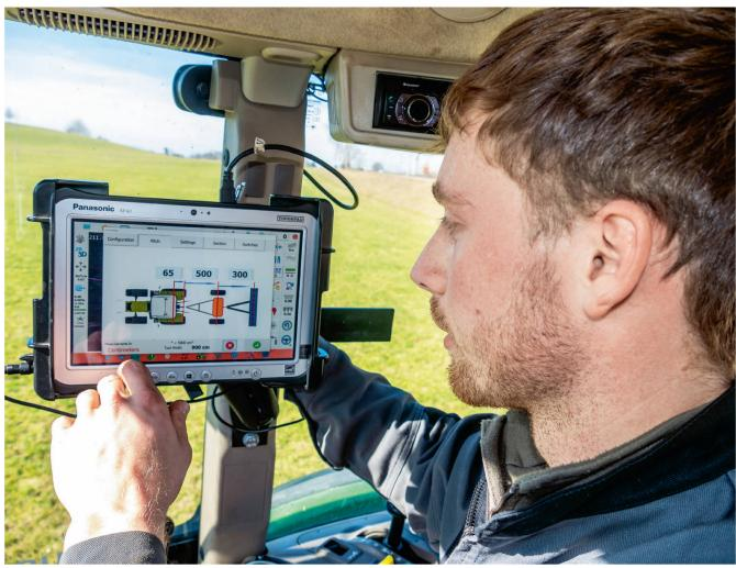
Andreas Pfister gibt auf einem handelsüblichen Windows-Tablet die notwendigen Parameter für die angebaute oder angehängte Maschine im «AgOpenGPS»-Programm für die bevorstehende Feldarbeit ein. Bilder: R. Engeler
