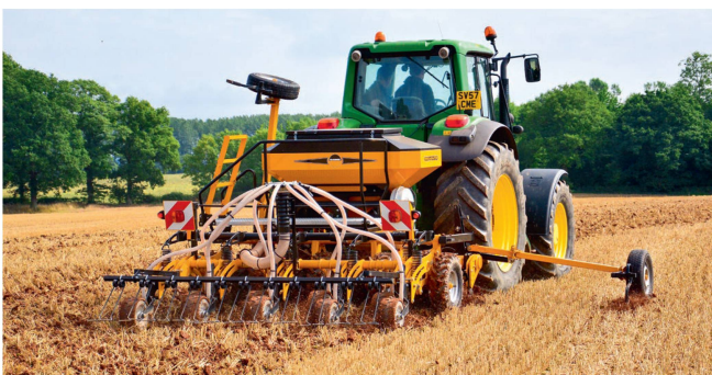
Strip-Till ist ein Verfahren, bei dem ein Streifen «passiv» bearbeitet und die Saat absätzlich oder gleichzeitig ausgebracht wird. Bild: McConnel
