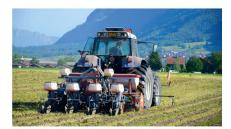
Bei der Streifenfrässaat wird der Boden mit einer Fräse streifenweise «aktiv» bearbeitet.
