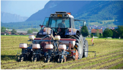
Bei der Streifenfrässaat wird der Boden mit einer Fräse streifenweise «aktiv» bearbeitet.
