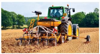
Strip-Till ist ein Verfahren, bei dem ein Streifen «passiv» bearbeitet und die Saat absätzig oder gleichzeitig ausgebracht wird. Bild: McConnel
