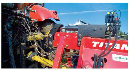
Bei dieser Schälfräse von Massano wurde eine automatische Tiefenführung für höchste Präzision eingebaut. Bild: R. Engeler
