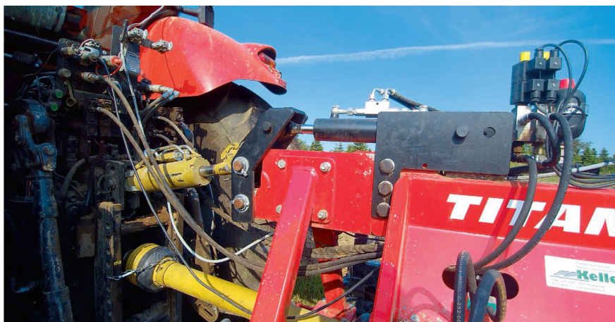
Bei dieser Schälfräse von Massano wurde eine automatische Tiefenführung für höchste Präzision eingebaut. Bild: R. Engeler
