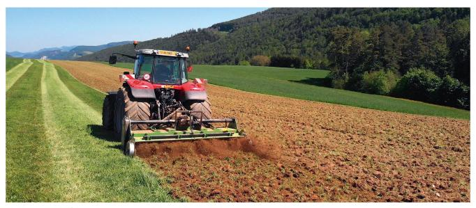
Die klassische Schälfräse sollte nur in optimal abgetrockneten Böden eingesetzt werden. Bild: R. Burkhalter
