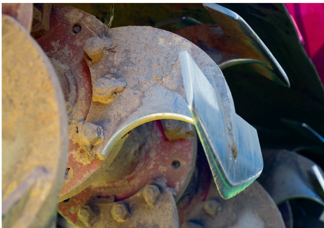
Beim «Geohobel» wird die Bodenstruktur aufgrund der langsam drehenden Hobelmesser am besten geschont. Bild: R. Hunger
