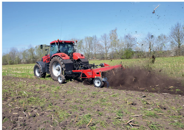
Der «Kvick Finn» arbeitet in zwei Phasen. Nach einer Vorlockerung durch Flügelschare folgt der Rotor. Bild: G. Zevenbergen
