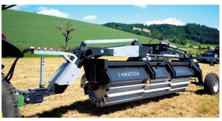
Die 4,5-t-Walze von Famatech kann dank Transportfahrwerk auch mit leichten Traktoren sicher transportiert werden.
