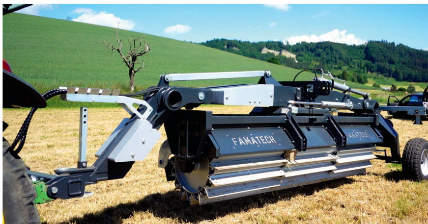
Die 4,5-t-Walze von Famatech kann dank Transportfahrwerk auch mit leichten Traktoren sicher transportiert werden.
