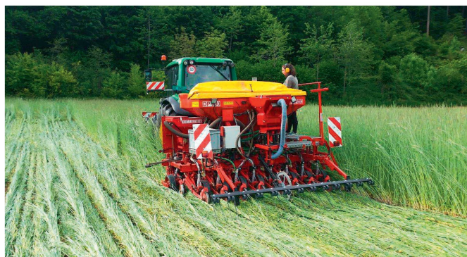
Für die Untersaat-Versuche wurde eine Drillmaschine so umgebaut, dass Mais und eine Untersaat in einem Durchgang ausgebracht werden können.
