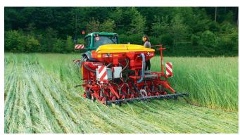
Für die Untersaat-Versuche wurde eine Drillmaschine so umgebaut, dass Mais und eine Untersaat in einem Durchgang ausgebracht werden können.
