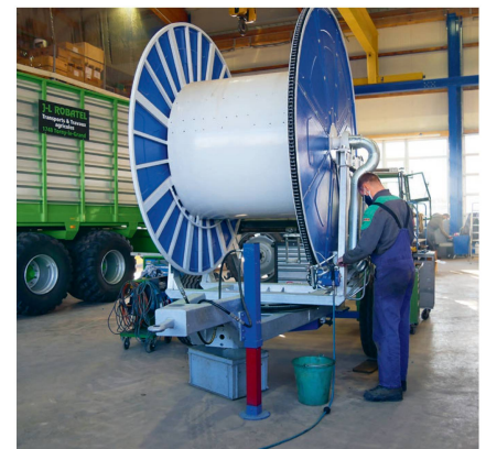
Blick in die neue Montagehalle. Hier wird ein Schlauchhaspel zusammengestellt.
