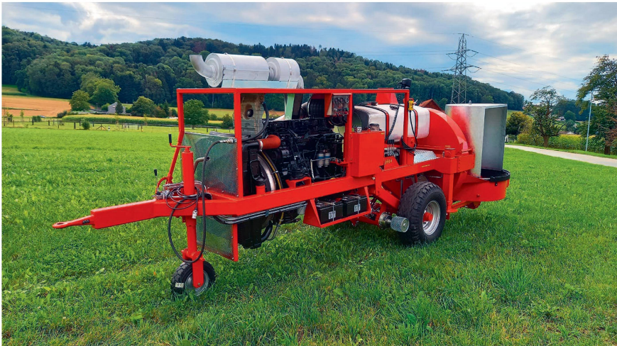
Das Häckselgebläse «HG 448-12» mit Lkw-Motor hat Strebel 2018 komplett überarbeitet und mit neuen Förderorganen versehen.
