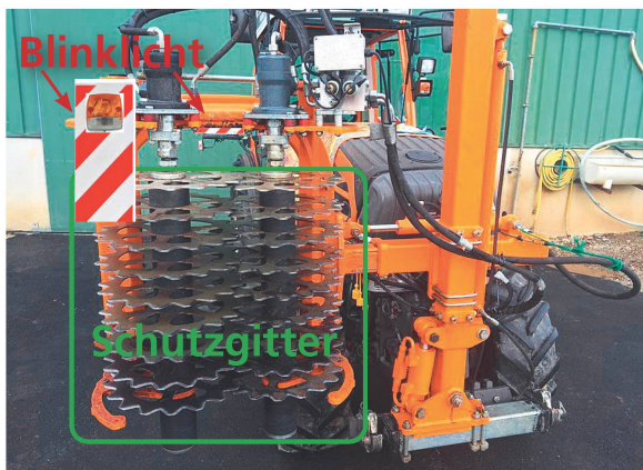
Zwingend notwendig für die Zulassung zum Strassenverkehr sind ein Schutzgitter, eine Aussenmarkierung, ein Positionslicht und ein abnehmbares Blinklicht anzubringen. Bild: zvg
