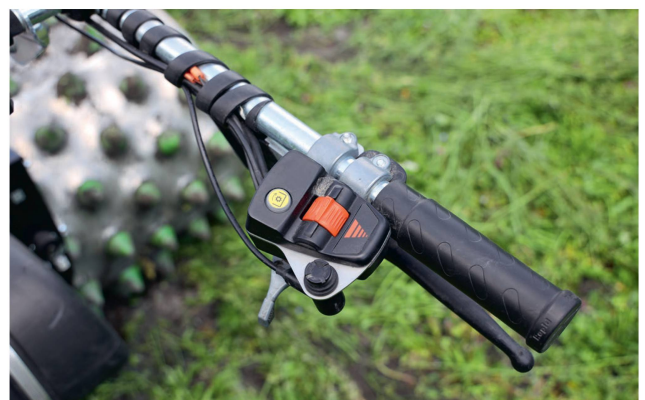
Am linken Lenkholm befindet sich eine Drehwippe für die Wahl der Fahrtrichtung, rechts ist die Wippe für die Vorgabe des Tempos.
