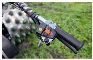
Am linken Lenkholm befindet sich eine Drehwippe für die Wahl der Fahrtrichtung, rechts ist die Wippe für die Vorgabe des Tempos.
