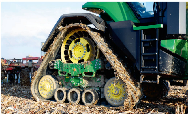
Triangel-Raupenlaufwerke haben mehr als doppelt so grosse Aufstandsflächen.
