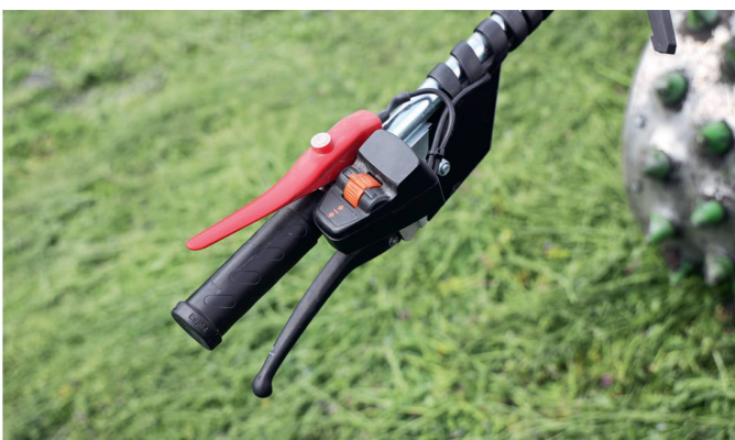
Am linken Lenkholm befindet sich eine Drehwippe für die Wahl der Fahrtrichtung, rechts ist die Wippe für die Vorgabe des Tempos.
