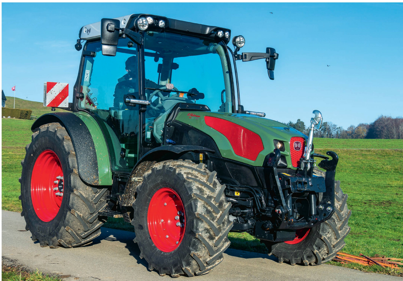
Der Hürlimann «XA 110.4 V-Drive» ist ein agiles Leichtgewicht, dessen 4-Zylinder-Motor die Abgasnorm der Stufe 3b erfüllt. Bilder: R. Engeler
