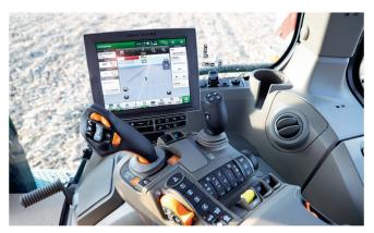
Die Bedienung mit Display ist bei den «8RX» Raupentraktoren analog den Radtraktoren.
