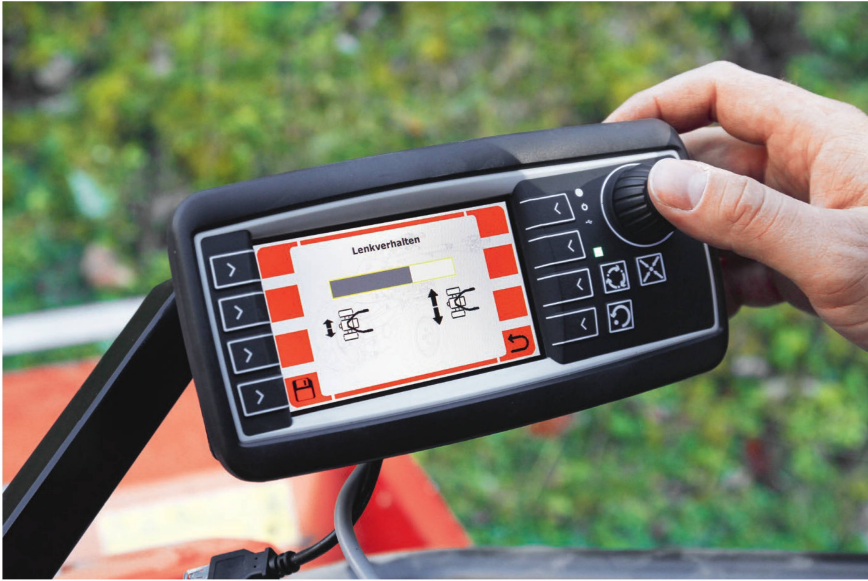
Mit diesem Diagnosemodul lässt sich die Bedienung des Motormähers auf die Bedürfnisse des Fahrers abstimmen.
