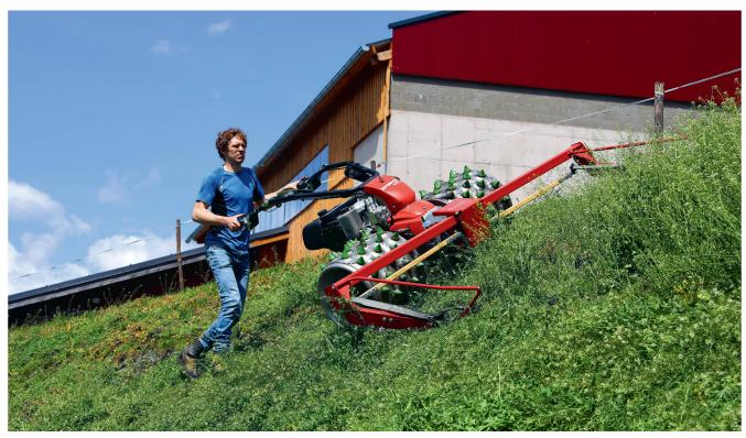
Die «DualDrive»-Steuerung der «Motech»-Mäher von Reform ermöglicht ein ermüdungsärmeres Fahren als mit der Drehgriffsteuerung. Bilder: J. Paar
