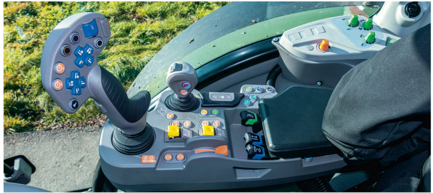
Dank vier frei belegbaren Knöpfen kann man die Funktionen von Armlehne und Fahrhebel den individuellen Bedürfnissen anpassen.
