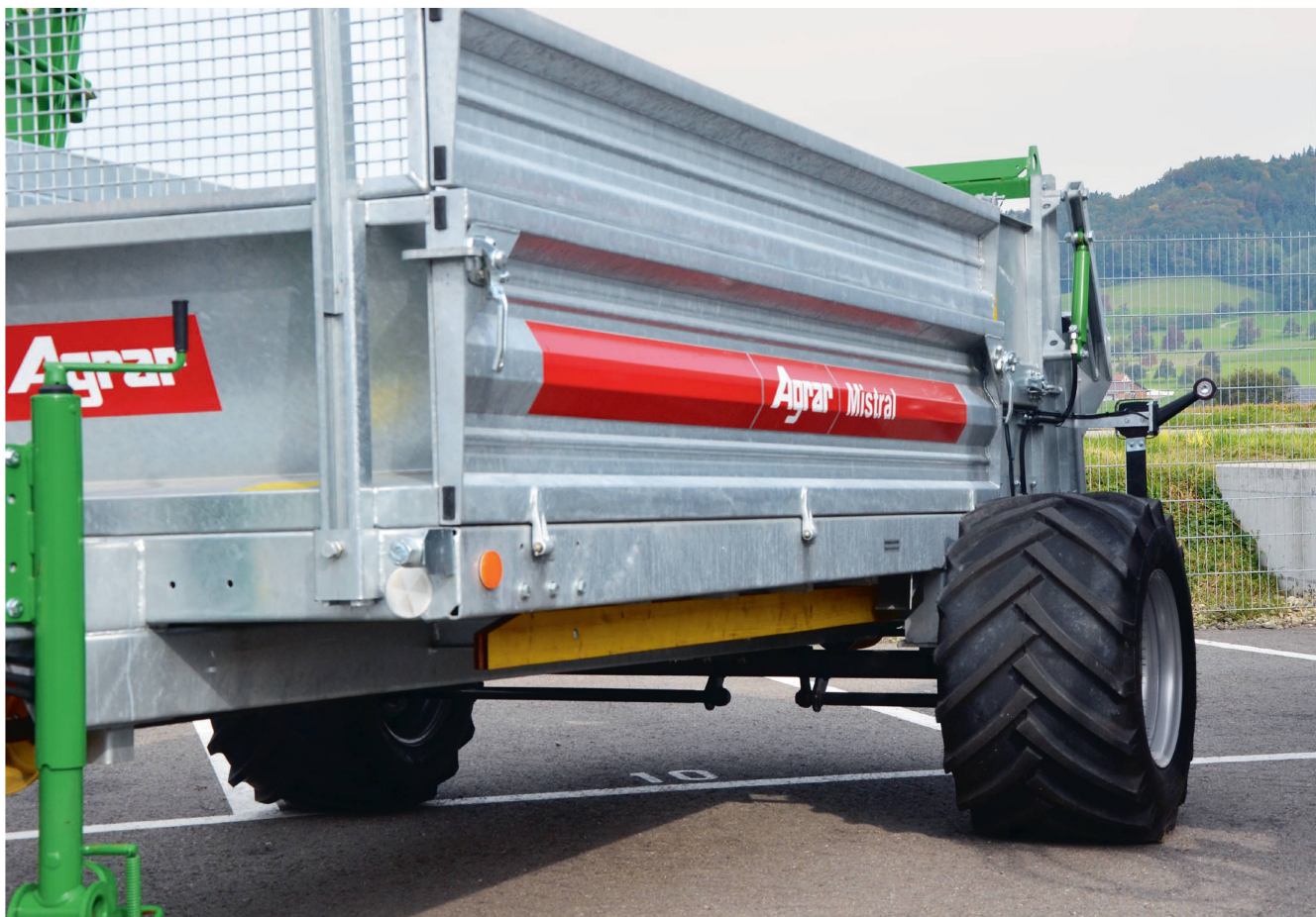
Der klassische Bergstreuer ist auf die Achse abgesetzt und hat stehende Streuwalzen. Bild: R. Hunger
