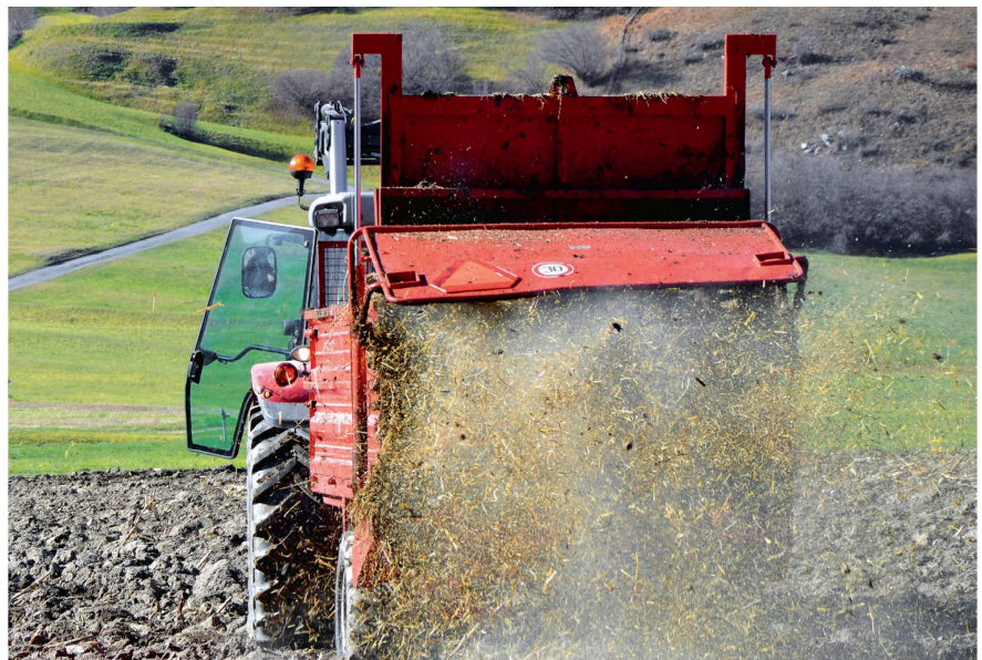
Weit verbreitet sind Miststreuer mit vier stehenden Streuwalzen. Bild: R. Hunger
