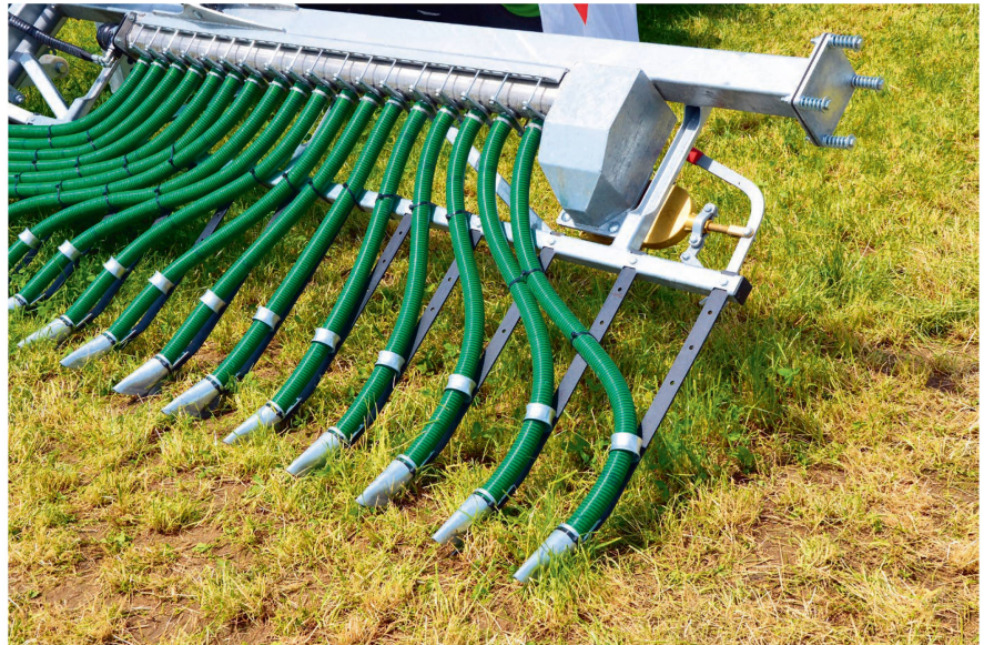
Schleppschuhe ritzen den Boden bzw. die Grasnarbe gerade so stark, dass die Gülle rasch versickert.
