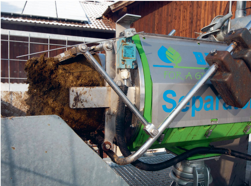
In der Schweiz werden laut einer Umfrage mehr fest installierte Separatoren eingesetzt als mobile. Pro Tonne Festphase werden rund 2 m 3 Lagerraum benötigt. Bild: Bauer
