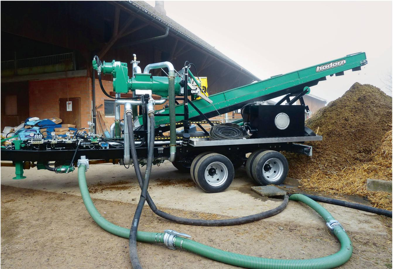
Für die Separierung von Rindergülle und Gärrest kommen in der Praxis derzeit fast ausschliesslich Pressschneckenseparatoren zum Einsatz. Mobile Separatoren, wie hier im Bild, werden oftmals von Lohnunternehmern oder Maschinenringen angeboten. Bild: Hadorn
