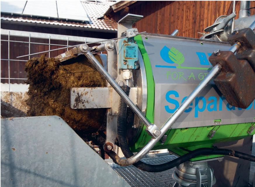
In der Schweiz werden laut einer Umfrage mehr fest installierte Separatoren eingesetzt als mobile. Pro Tonne Festphase werden rund 2 m<sup>3</sup> Lagerraum benötigt. Bild: Bauer
