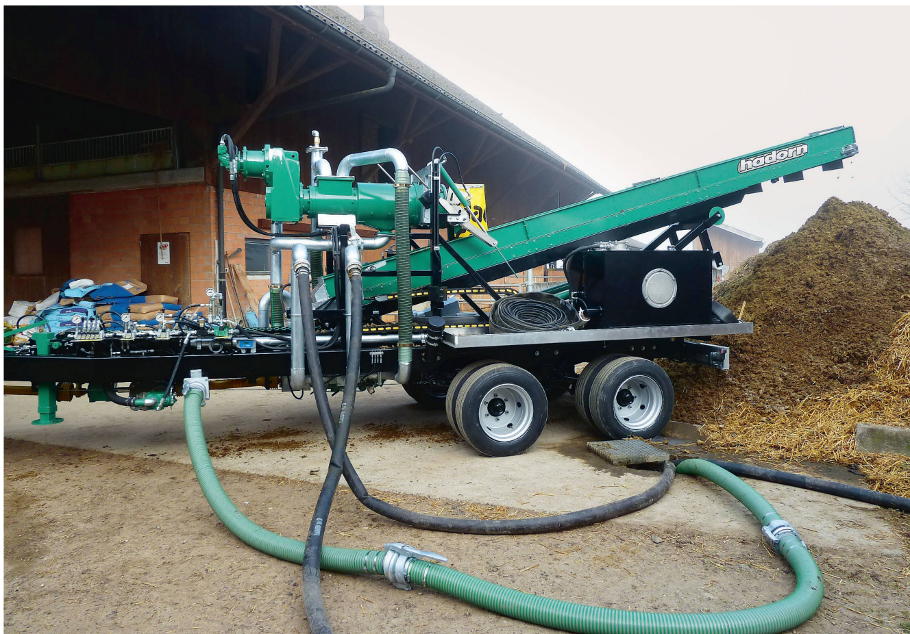
Für die Separierung von Rindergülle und Gärrest kommen in der Praxis derzeit fast ausschliesslich Pressschneckenseparatoren zum Einsatz. Mobile Separatoren, wie hier im Bild, werden oftmals von Lohnunternehmern oder Maschinenringen angeboten. Bild: Hadorn
