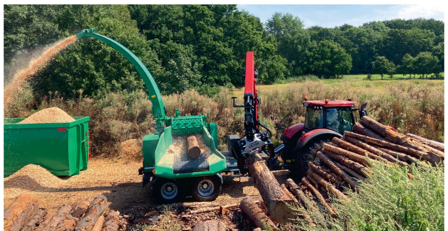
Anhänge-Trommelhacker von Jenz mit Traktorantrieb. Bilder: C. Brüggemann
