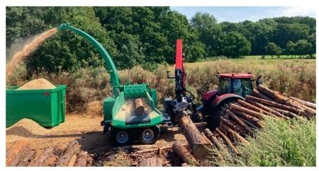
Anhänge-Trommelhacker von Jenz mit Traktorantrieb. Bilder: C. Brüggemann
