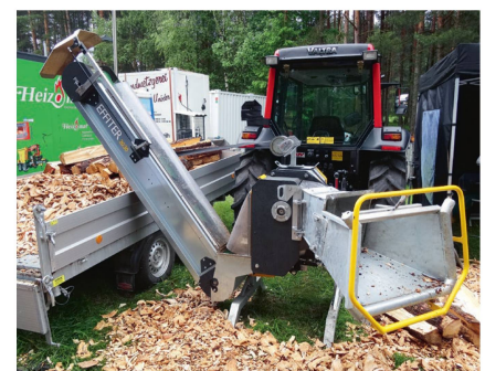
Schneckenhacker «Effiter» im Traktoranbau von Alvatec.
