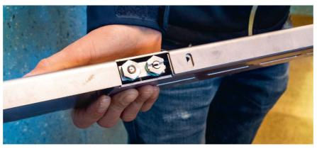
Die Düsenanlage befindet sich in dieser Edelstahl-Schiene: rechts die Düse zum Waschen, links jene fürs Desinfizieren.
