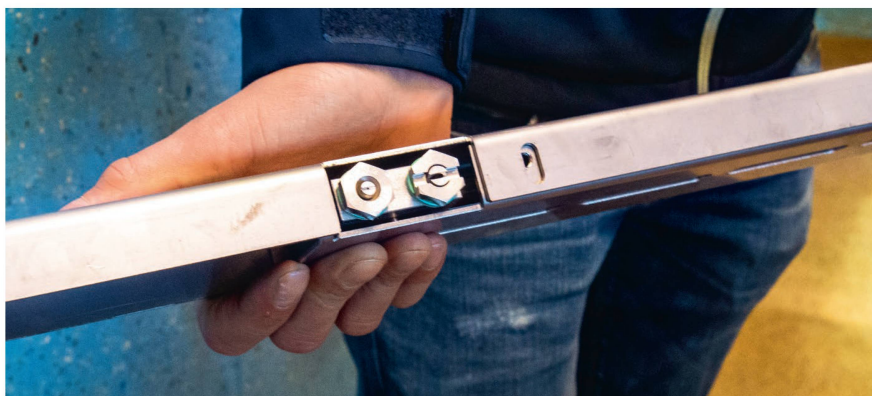
Die Düsenanlage befindet sich in dieser Edelstahl-Schiene: rechts die Düse zum Waschen, links jene fürs Desinfizieren.
