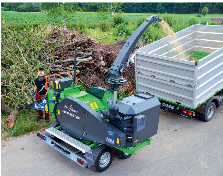
Trommelhacker der Marke «Heizohack» mit eigenem Aufbaumotor.
