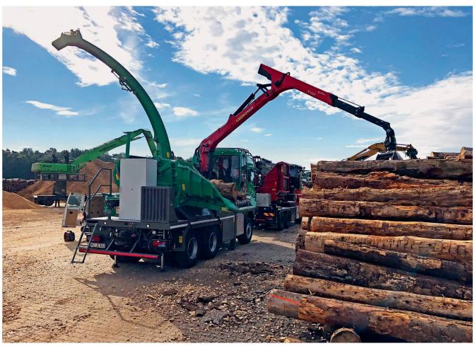
Im finalen Test hat sich gezeigt, dass durch den Hybrid-Antrieb bei einem Holzhacker im Vergleich zu einem herkömmlichen Modell bis zu 20% Diesel-Treibstoff eingespart werden können. Bilder: H. Fischer, TH Köln
