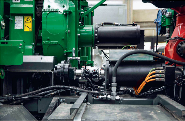
Neben dem dieselbetriebenen Motor, der sowohl den LKW-Antrieb als auch das Hackgerät mit Energie versorgt, verfügt das Fahrzeug nun zusätzlich über einen elektrischen Antrieb (rechts unten).
