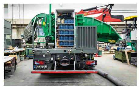
Überschüssige Energie wird in 13 sogenannten Superkondensatoren (Mitte) gespeichert und kann im Boost-Modus wieder genutzt werden.
