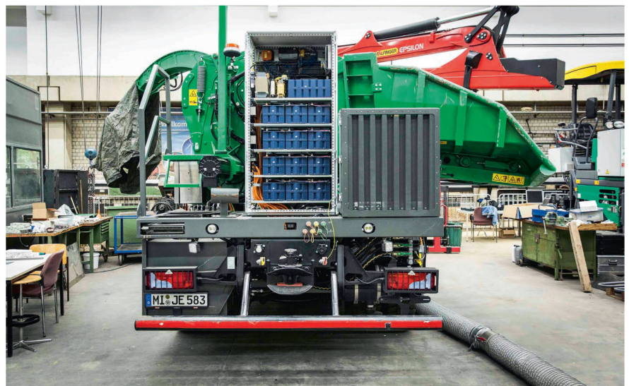
Überschüssige Energie wird in 13 sogenannten Superkondensatoren (Mitte) gespeichert und kann im Boost-Modus wieder genutzt werden.
