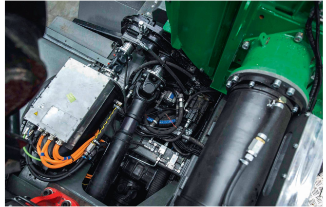
Der Hybrid-Antrieb (links) unterstützt den Hacker, wenn mehr Leistung gebraucht wird, als der Verbrenner im optimalen Betriebspunkt bereitstellen kann.
