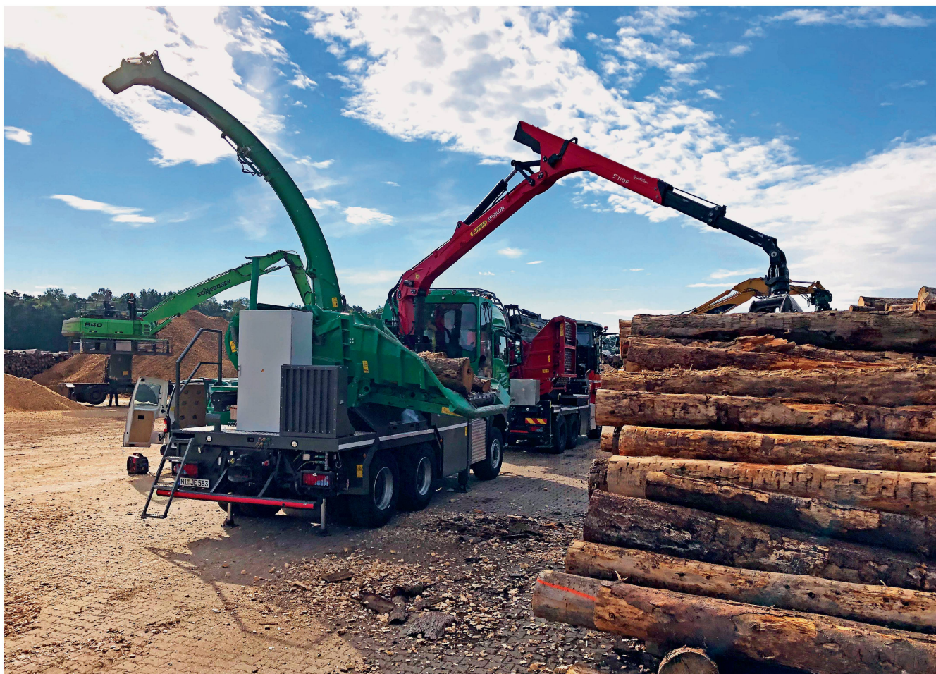
Im finalen Test hat sich gezeigt, dass durch den Hybrid-Antrieb bei einem Holzhacker im Vergleich zu einem herkömmlichen Modell bis zu 20% Diesel-Treibstoff eingespart werden können. Bilder: H. Fischer, TH Köln
