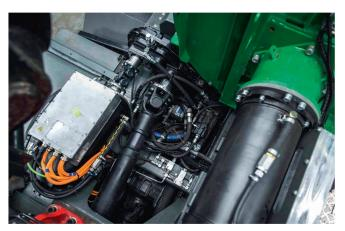
Der Hybrid-Antrieb (links) unterstützt den Hacker, wenn mehr Leistung gebraucht wird, als der Verbrenner im optimalen Betriebspunkt bereitstellen kann.
