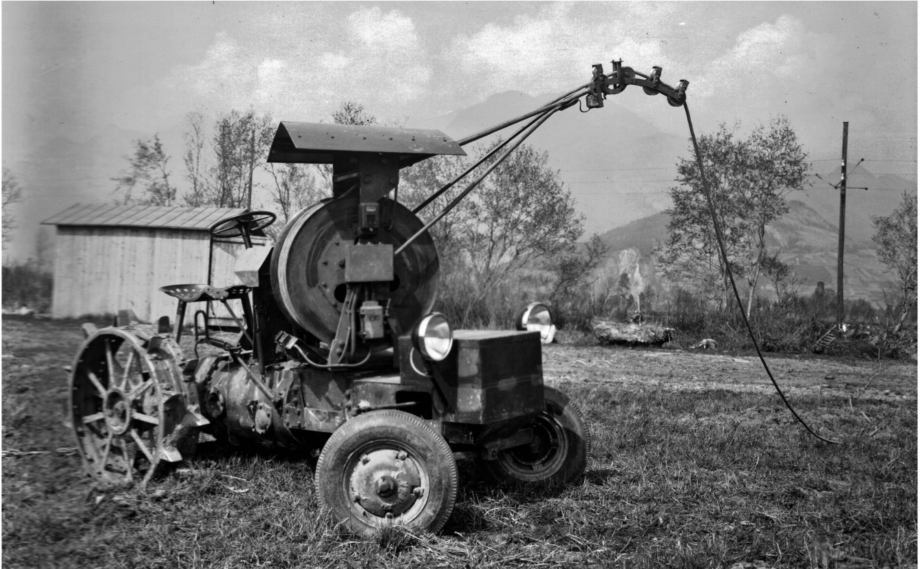
Vor 80 Jahren, 1941, warteten die Ateliers de Constructions Mécaniques de Vevey (ACMV) mit dem vermutlich ersten Elektro-Traktor der Welt auf. Hier die Ausführung mit dem Allis-Chalmers-Chassis, mit dem Stromabnehmer (Trolley) rechts vom Traktor und der drehbaren Kabelrolle mit Gestänge und Kabel auf dem Traktor, darunter der Kasten des Kabelrollenmotors sowie links unter der Kabelrolle die beiden Antriebe.
