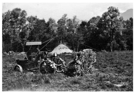
Der Vevey-Elektro-Traktor beim Wurzelstock-Abtransport; die Kabelrolle hat 400 m Kabel aufgewickelt.
