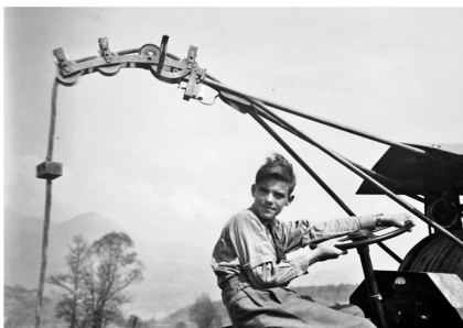
Das Gestänge mit den vier Laufrollen (und kleinen Gegenrollen) und dem Kontaktschalter. Die Rolle wird immer in die jeweilige Arbeitsrichtung gedreht.
