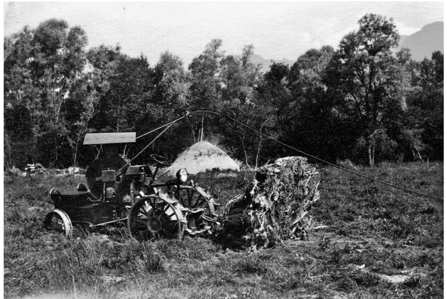
Der Vevey-Elektro-Traktor beim Wurzelstock-Abtransport; die Kabelrolle hat 400 m Kabel aufgewickelt.
