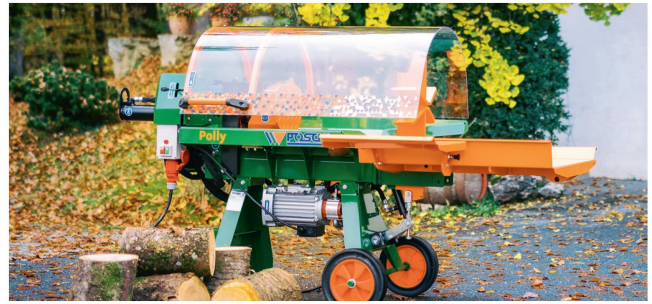
Waagerecht arbeitender Kleinspalter, GS-geprüft nach der neuen Norm DIN EN 609-1,2017.
