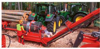
Mit dem Schneidspalter wird der Stamm auf die gewünschte Länge gesägt und gespalten.
