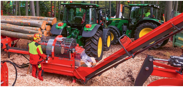
Mit dem Schneidspalter wird der Stamm auf die gewünschte Länge gesägt und gespalten.
