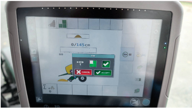
(Bild links): Der aktuelle Verbindungsstatus zwischen Traktor und Rundballenpresse. Die einzelnen Zugriffe der Presse müssen einmalig vom Fahrer freigegeben werden. (Bild rechts): Die «TIM»-Benutzeroberfläche am Traktorterminal.
