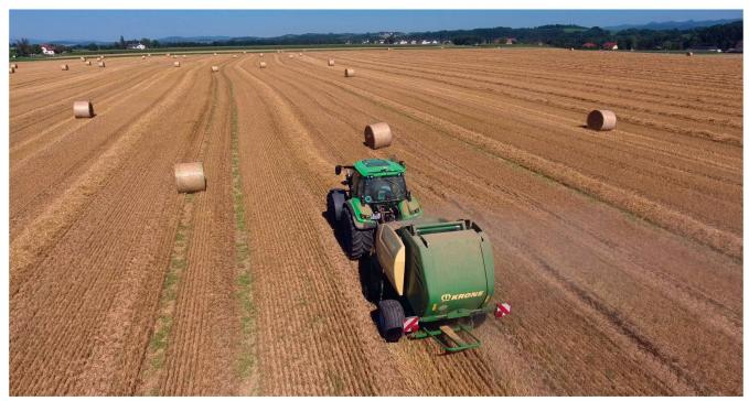
Ein «Tractor Implement Management»-System (TIM) greift auf die Arbeitsabläufe des Traktors zu. Im Beispiel der Rundballenpresse wird der Traktor angehalten und die Ballenkammer sowie der Ballenauswerfer bedient. Fotos und Grafiken: Innovation Farm
