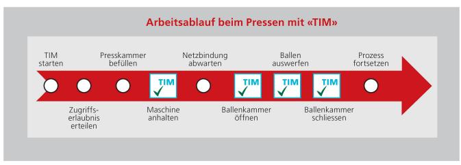
«TIM» greift mehrmals in den Arbeitsablauf beim Pressen ein: Das System hält den Traktor an, öffnet und schliesst die Ballenkammer und wirft dazwischen die Balle aus.
