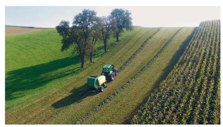
Am Hang erfolgt die Ballenablage wie gewohnt nur auf der Kuppe oder beim Einknicken der Presse über 90° (sodass das Heck leicht hangaufwärts schaut).
