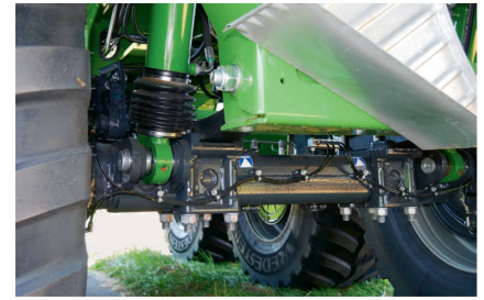
Das Tridem-Fahrwerk mit hydraulischem Niveau-Ausgleich: Die vordere Achse ist eine Lift-Achse.
