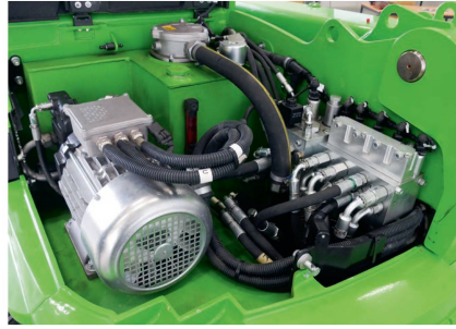
Einer der insgesamt drei verbauten Elektro-Motoren ist für den Antrieb der Hydraulik zuständig.
