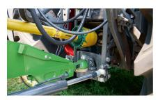
Der Wagen ist über eine Untenanhängung und zwei Stangen zur Zwangslenkung mit dem Zugfahrzeug verbunden.
