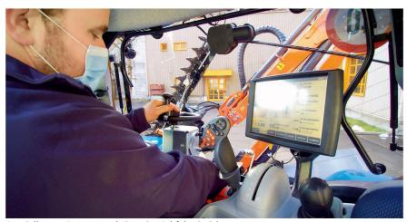
Spezielle Ausrüstung: Drehsitz mit Rückfahreinrichtung.
