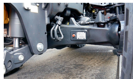
Die Federung der «Terraglide»-Vorderachse kann manuell eingestellt werden.
