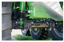
Das Tridem-Fahrwerk mit hydraulischem Niveau-Ausgleich: Die vordere Achse ist eine Lift-Achse.
