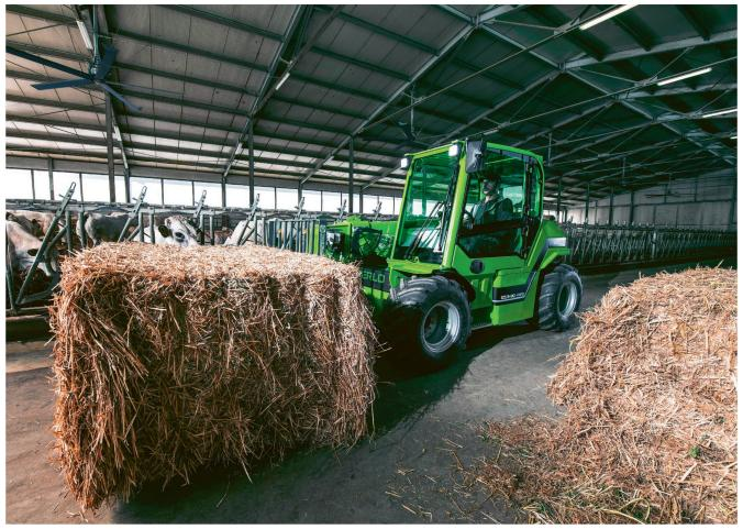
Mit dem vollelektrischen Teleskoplader «e-Worker» hat Merlo jetzt eine Maschine im Angebot, die auch innerlich mit «grünen» Werten überzeugen soll. Bild: Merlo
