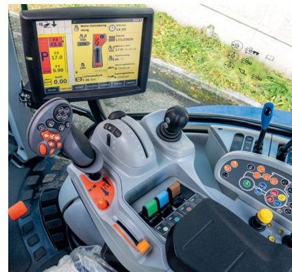
Die «Sidewinder II»-Armlehne ist elektrisch verschiebbar. Mit Bildschirm, Fahrhebel und Kreuzhebel für die Hydraulik hat man alle Funktionen im Griff.
