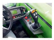
Blick auf die Anzeige-Instrumente und auf den kapazitiven Joystick in der Kabine.
