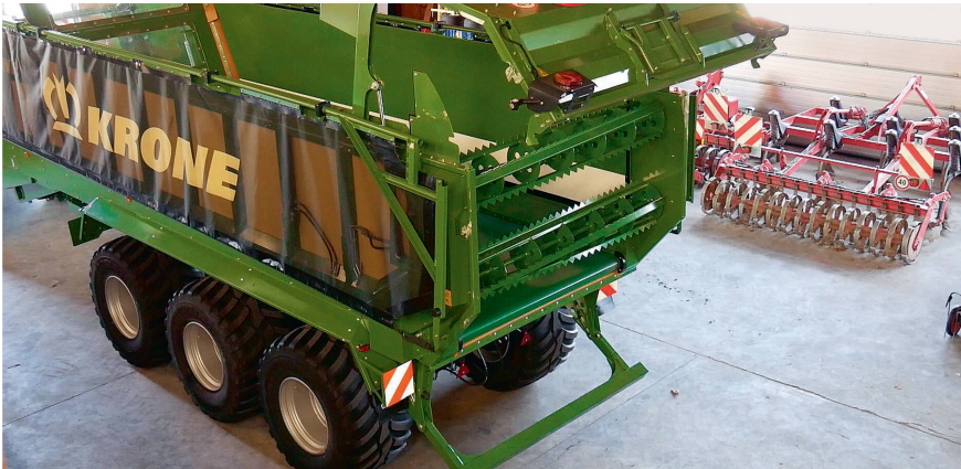
Der Bandabschiebewagen mit geöffneter Heckklappe, den beiden Dosierwalzen und mit der sich nach hinten bewegenden Abschiebewand. Die Abschiebewand kann bis ans Ende der Ladeplattform geschoben werden.
