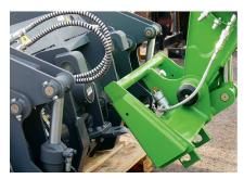
Der Anbau von Geräten erfolgt über die bekannte «ZM-1»-Aufnahme mit integrierter hydraulischer Verriegelung.
