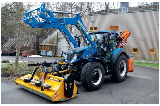
Der New Holland «T5.130 AC» in voller Montur mit Frontlader, Mulchgerät und Heck-Böschungsmäher. Bilder: H. Röthlisberger, R. Engeler
