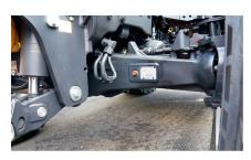
Die Federung der «Terraglide»-Vorderachse kann manuell eingestellt werden.
