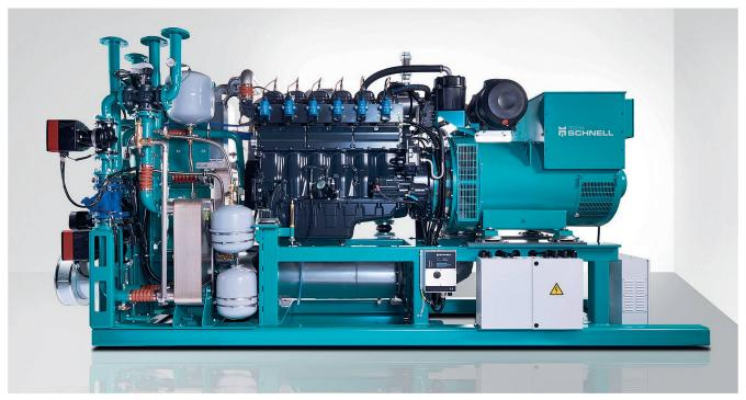
«Tedom Schnell» baut BHKW-Aggregate von 170 bis 525 kW elektrischer Leistung. Bild: Tedom Schnell
