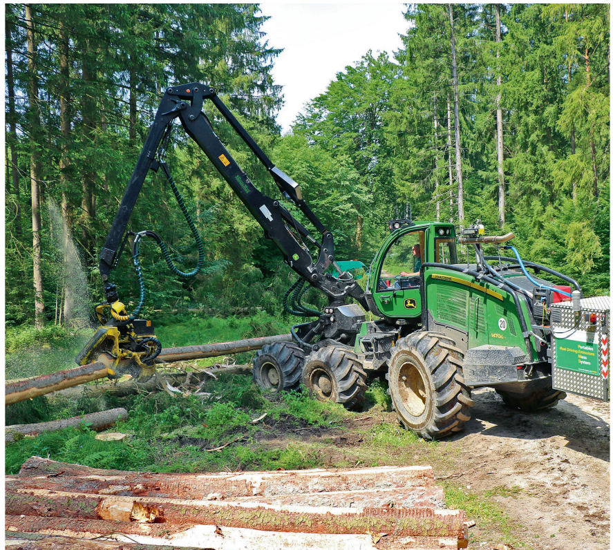
PEMS-Aufbau am Heck eines Harvesters im Praxiseinsatz. Bild: TFZ
