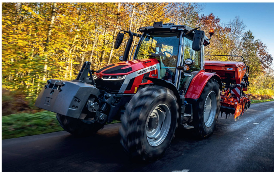
Mit der durchgehenden Hubkraft im Heck von 5700 kg und dem zulässigen Gesamtgewicht von 9,5 t können die «MF 5S»-Traktoren auch grössere Anbaugeräte handhaben. Bild: MF
