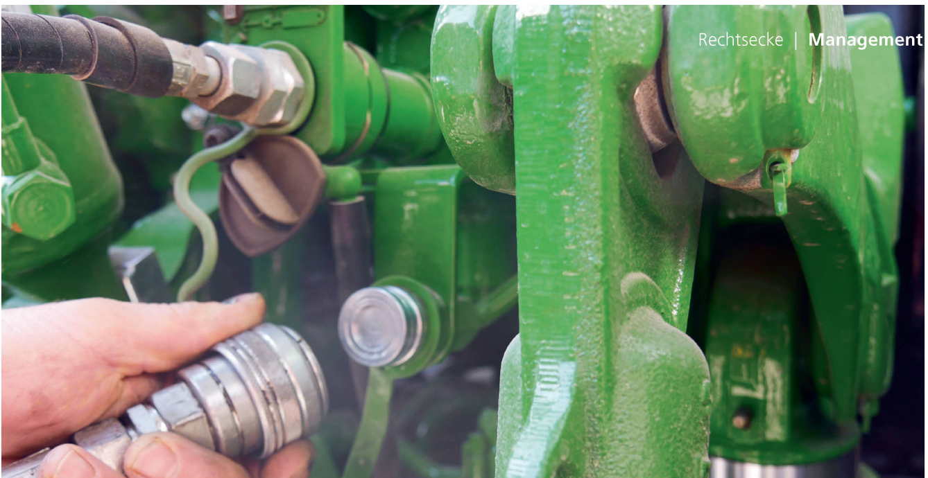
Noch bis Ende 2025, aber nur unter Einhaltung gewisser Vorgaben erlaubt: das Ankoppeln eines Anhängers mit H2L-Bremssystem an einen Traktor mit H1L-Bremsanlage. Bild: R. Engeler
