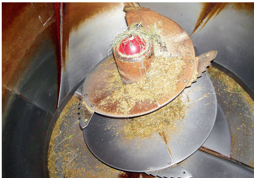
Messer an einer Mischschnecke sind kontinuierlichem Verschleiss unterworfen und beeinflussen deshalb auch den Treibstoffverbrauch. Bilder: R. Hunger
