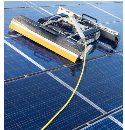
Vorher (unten) – nachher (oben): Dank zweier Bürsten ist der Reinigungseffekt gross.
