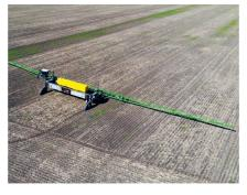
Dies erhöht den Wirkungsgrad im Vergleich zu Traktorgespannen. Bei der 14-m-Version werden im angestrebten Beetmodus 95% der gesamten Ackerfläche systembedingt nie überfahren, wodurch sich hohe Ertragspotentiale bei guter Boden- und Umweltschonung erschliessen lassen.
