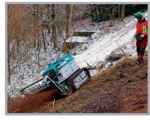
Pfanzelt hat für die zweite Generation des Raupengeräteträgers «Moritz Fr75» eine silberne Auszeichnung erhalten. Der «Moritz Fr75» vereint die Eigenschaften einer Forst- und einer Funkraupe. Die Dreipunktaufnahmen-Verbindung mit mechanischer Zapfwelle, Leistungshydraulik und sechs Hydraulikfunktionen ermöglicht den herstellerunabhängigen Geräte-Anbau.
