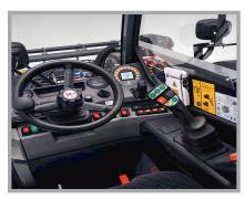
Eine Demopark-Silbermedaille gibt es zudem für den «Electronic Controlled Drive» («ec-Drive») von Hersteller Weidemann. Mit dem elektronisch geregelten Antrieb mit vier Modi können Arbeitsmaschinen bedarfsgerecht gefahren werden. Beim Anbaugeräte-Modus wird bei steigender Belastung automatisch die Fahrgeschwindigkeit zurückgenommen.
