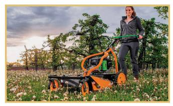
AS-Motor mit Firmensitz in Bühlertann (D) gehört seit kurzem zur Ariens-Firmengruppe und hat eine Goldmedaille für die neuen Hochgrasmäher mit Elektroantrieb bekommen. Die «EAllmäher» des Herstellers AS-Motor sind die ersten Hochgrasmäher mit Elektroantrieb. Verwendet werden zwei 56-Volt-Hand-Akkus. Mehr Reichweite kann mit einem zusätzlichen rückentragbaren Akku erreicht werden. Die Leistung der Profimäher ist vergleichbar mit der eines 200-ccm-4-Takt-Motors.
