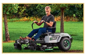
Gold geht auch an die Firma EGO, Hersteller von Akku-Geräten mit Sitz in den USA, für ihren Akku-Null-Wendekreis-Mäher «ZT4200E-L». Bei einer Schnittbreite von 106 cm erreicht dieser akkubetriebene Null-Wendekreis-Mäher eine Flächenleistung von bis zu 10000 m² mit einer Ladung. Verwendet werden sechs 56-V-Akkus, die gewechselt werden können. Es sind dieselben Typen, wie sie bei den Handgeräten von Ego zum Einsatz kommen.
