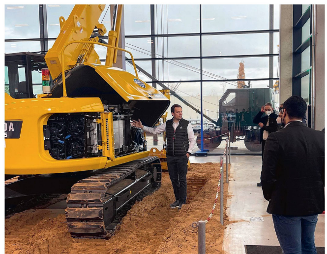
In Zusammenarbeit mit dem japanischen Hersteller Maeda hat Deutz einen vollelektrischen 40-kW-Raupenkran mit 6 Tonnen Tragkraft entwickelt. Bild: Deutz
