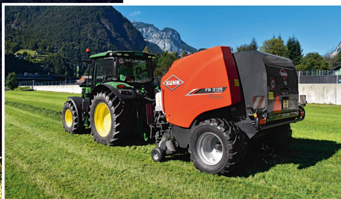
Die Maschine mit zuführendem Integralrotor und dem Folienbindungs-System «Twin-Reel» überzeugt in der Silage.
