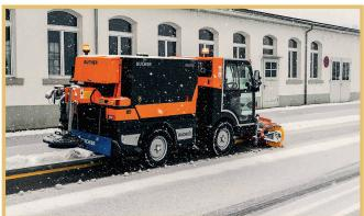
Bucher-Municipal in Niederweningen erhält Gold für die Kompaktkehrmaschine «CityCat V20e» mit Solestreuer «Husky L14e». Die knickgelenkte Elektro-Kompakt-Kehrmaschine mit einem Volumen von 2 m³ hat ein Batterie-Paket, das für eine Acht-Stunden-Arbeitsschicht ausreicht. Für den Ganzjahreseinsatz kann das Fahrzeug mit einem vollintegrierten elektrischen 1400-l-Solestreuer ausgerüstet werden. Dieser hat eine eigene Stromversorgung. Durch das Batterie-Puffersystem arbeitet er eigenständig
