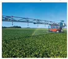
und hydraulisch klappbaren 66 m langen Aluminiumgestänge besteht. Die Vorteile der beiden aktuell verbreiteten Verfahren (Selbstfahrer und Düsenwagen) werden in einer Maschine kombiniert.
