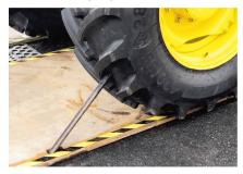
Fremdkörper das Leck ab. Trotz Beschädigung kann weitergefahren und der Reifen zu einem späteren Zeitpunkt repariert oder ausgetauscht werden.
