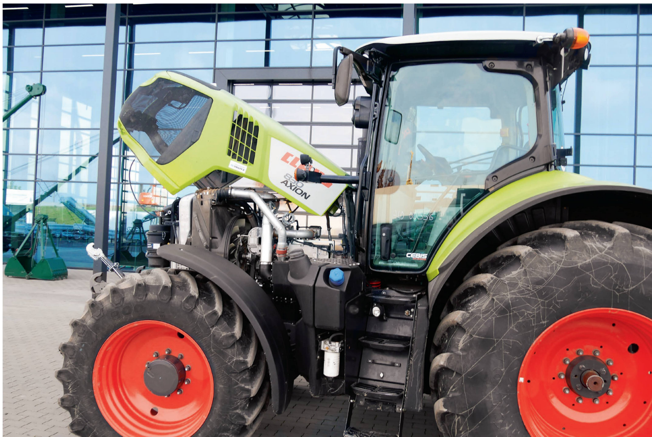
Motoren-«Downsizing» von 6 auf 4 Zylinder. Trotz Verkleinerung des Hubraums hat der Claas «Axion 830» die gleiche Leistungsfähigkeit und mit zweitem Elektro-Turbolader zudem bessere Drehmomentwerte sowie mehr Platz unter der Haube. Bilder: H. Röthlisberger
