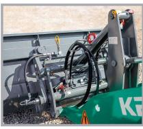
Silber gibt es für die Kramer-Werke für den Schnellkoppler «Smart Attach». Mit dem vollhydraulischen Schnellwechsler «Smart Attach» können hydraulische Anbaugeräte von Ladern aus der Kabine heraus gekoppelt werden. Die Verbindung mit dem Hydraulikkreislauf erfolgt automatisch. Das ist effizient und sicher, weil nicht mehr abgestiegen werden muss. Zudem tritt kein Lecköl aus.
