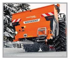
Amazone erhält eine Silbermedaille für den Winterdienststreuer «IceTiger». Beim Winterdienststreuer «IceTiger» des deutschen Herstellers sorgt die Kombination aus einem hydraulisch angetriebenem Bandboden, elektrischer Aufgabepunktverstellung und der Bedienung über Isobus-Terminal für eine präzise Ausbringung des Streugutes, auch in Kleinstmengen von 5 g/m². Durch die breite Auflagefläche des Bandes wird Brückenbildung vermieden.
