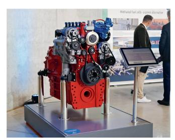
Der 6-Zylinder-Wasserstoffmotor von Deutz mit 200 kW (270 PS) Leistung. Eine Verwendung bei Landwirtschafts- und Baumaschinen ist nicht ausgeschlossen, aber noch in weiter Ferne.
