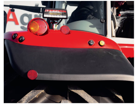
Externe Bedienung von Hubwerk, Steuerventil und der Zapfwelle. Zudem lässt sich eine gespeicherte Motordrehzahl abrufen.
