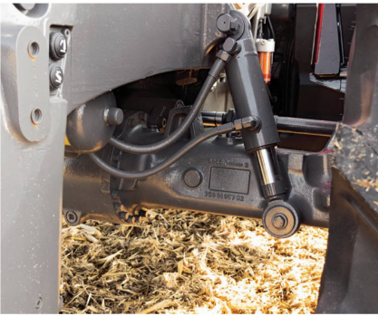
Die gefederte Vorderachse mit einem Federweg von 140 mm ist Standard beim «MF 75.190».
