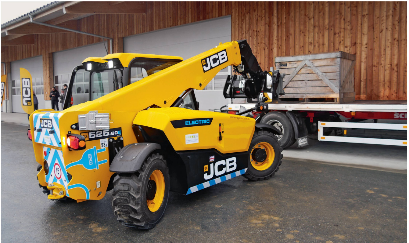
Abgasfrei und leise unterwegs: Der Elektro-Teleskopler JCB «525-60E» mit 96-V-Lithium-Ionen-Batterie ist mit zwei separaten Elektromotoren ausgerüstet. Bilder: H. Röthlisberger
