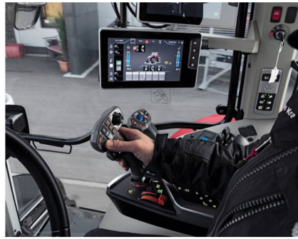
Aufgefrischtes Design im Kabinen-Inneren mit den beiden Joysticks und Touchscreen «Datatronic 5».
