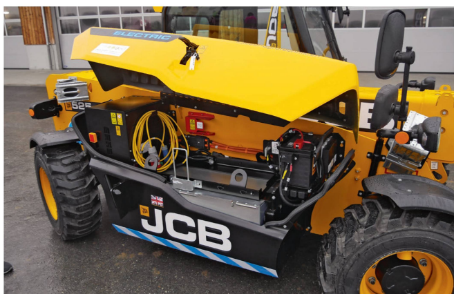
Die 96-V-Lithium-Ionen-Batterie hat eine Kapazität von 24 kWh. Geladen wird über Standardstromversorgung. Optional gibt es ein Schnellladegerät.
