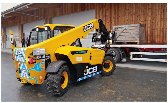
Abgasfrei und leise unterwegs: Der Elektro-Teleskoplader JCB «525-60E» mit 96-V-Lithium-Ionen-Batterie ist mit zwei separaten Elektromotoren ausgerüstet. Bilder: H. Röthlisberger
