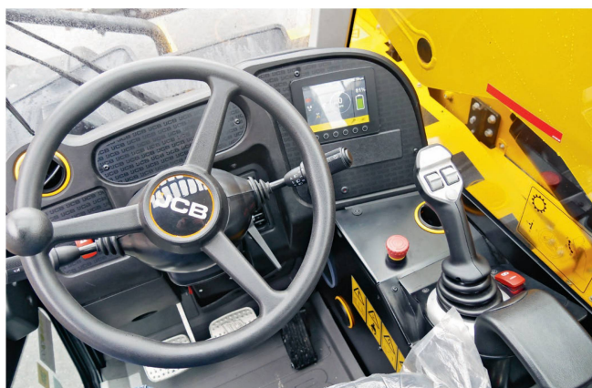
JCB hat dem Elektro-Teleskoplader ein neues Bedienfeld sowie ein neues Display spendiert. Eingebaut ist auch die patentierte Lastmoment-Kontrolle «Load Control».
