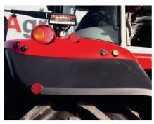
Externe Bedienung von Hubwerk, Steuerventil und der Zapfwelle. Zudem lässt sich eine gespeicherte Motordrehzahl abrufen.
