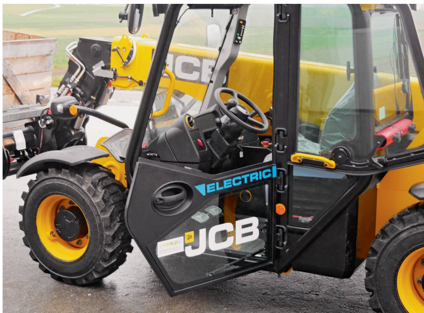
Die Kabine mit zweiteiliger Türe verfügt über eine 2,2-kW-Heizung sowie beheizte Front-, Heck- und Seitenscheiben. Damit werden sie schnell enteist und auch beschlagfrei.
