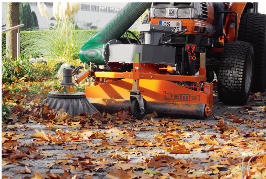
Eine Saug-Kehreinheit mit aufgebautem Häckselgebläse beseitigt Laub gründlich und sauber. Bild: Bema
