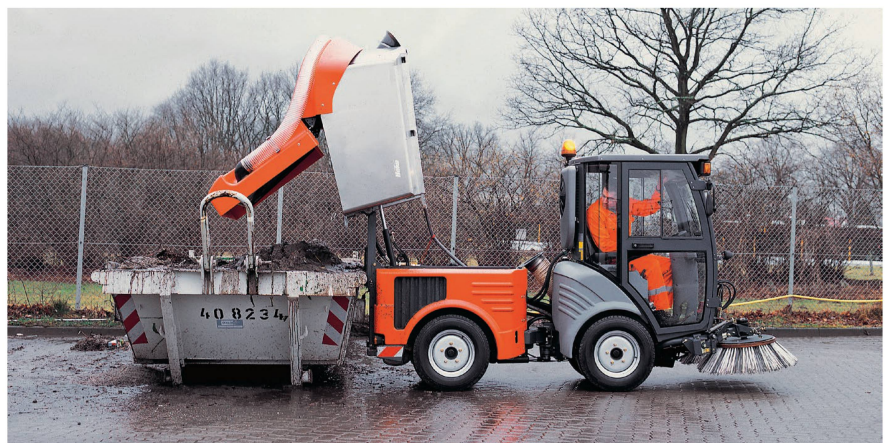
Knicklenker eignen sich gut als Trägerfahrzeug für kompakte Saug-Kehrsysteme. Bild: Hako
