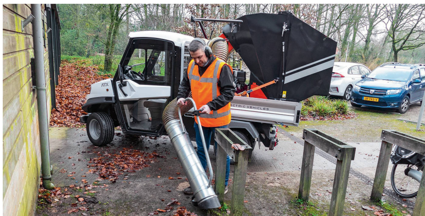
Ein einfaches Fahrzeug mit Sammelsack, Saugrohr und Handsaugdüse. Bild: zVg
