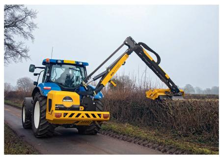
Mit einem Schlegelmäher/Mulcher kann nicht selektiv gearbeitet werden, es fällt kein Astmaterial zur Räumung an. Bild: McConnel
