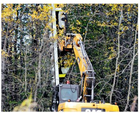
Fräsblattsysteme mit mehr als vier Fräsblättern brauchen ein entsprechend standfestes Trägerfahrzeug. Bild: zvg
