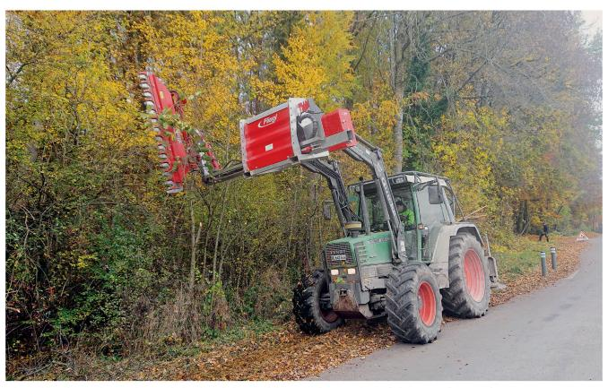
Scheren hinterlassen einen sauberen Schnitt, das Schnittmaterial muss in einem zweiten Arbeitsgang entfernt werden. Bild: H. Röthlisberger
