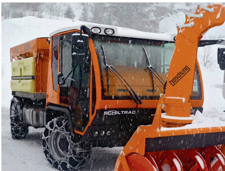
So kann man sich die Winterauslastung eines landwirtschaftlichen Transporters vorstellen, Streuer/Sole-Aufbauten und Schneefräse.
