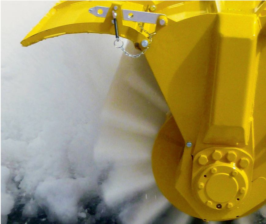
Es muss nicht immer ein Pflug sein, frische Schneemassen können mit rotierenden Bürsten sehr effizient entfernt werden.
