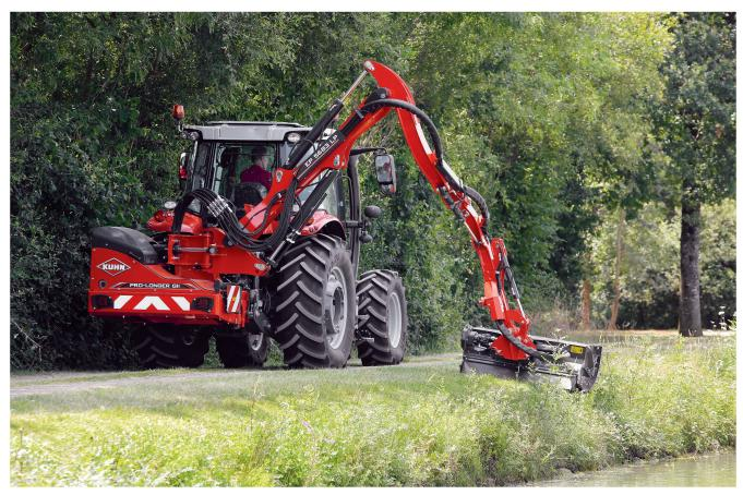
Mit einem Standardtraktor kann eine Mäh- oder Mulcheinheit problemlos am Ausleger geführt werden. Bild: Kuhn
