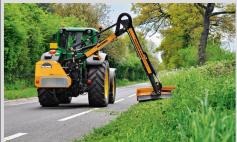
Mittlere Reichweite im Bereich von 4,0 bis 7,0 m oder grosse Reichweiten bis über 12,0 m, beides ist dann sinnvoll, wenn es ausreichend ist oder benötigt wird. Je weiter der Ausleger reicht, desto besser muss die Standfestigkeit des Trägerfahrzeugs sein.
