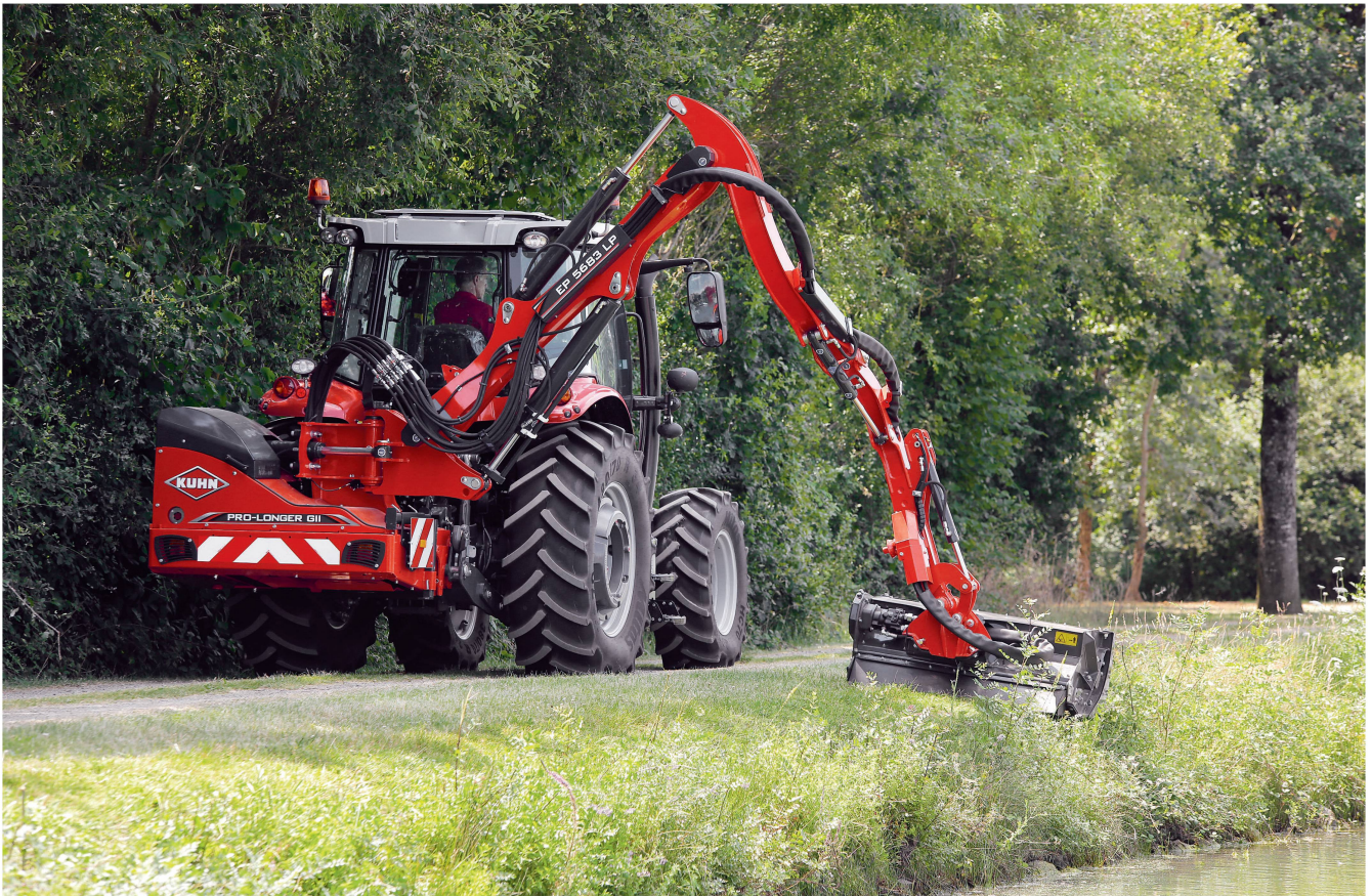
Mit einem Standardtraktor kann eine Mäh- oder Mulcheinheit problemlos am Ausleger geführt werden. Bild: Kuhn
