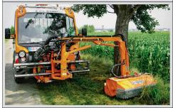
Die Definition «Böschungsmäher/ Mulcher» greift zu kurz: Die Gerätevielfalt ist so gross wie das mögliche Einsatzfeld. Als Anbauräume kommen sowohl der Front- als auch der Heckbereich des Fahrzeuges in Frage. Vereinzelt gibt es auch eine Zwischenachsanbaulösung.
