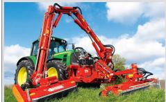
Gleich mehrere Bereiche können mit unterschiedlichen Mäh- und Mulchköpfen bearbeitet werden, wenn neben einem langen Auslegerarm zusätzlich ein kurzer für den Nahbereich vorhanden ist. Diese Variante kommt ausschliesslich für Arbeiten entlang von Strassen und (oder) den Strassenunterhaltsdiensten zur Anwendung.
