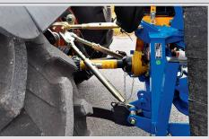
Die seitliche Ausladung überträgt nicht zu unterschätzende Torsionskräfte auf den Traktor. Für den Heckanbau gibt es zusätzliche Stabilisatoren. Einen speziellen Kommunalrahmen baut ein Valtra-Händler in Deutschland (Stegemann). Der Rahmen verteilt die auftretenden Kräfte gleichmässig.
