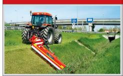
Der Arbeitsbereich eines Böschungsoder Seitenmulchers beginnt unmittelbar neben dem rechten Rad des Traktors. Damit dieser nicht auf der äussersten Kante fahren muss, haben die Mulcher einen Schiebebereich von 30 bis 40 cm. Der Böschungswinkel beträgt –65° (abwärts) und +90° (aufwärts).
