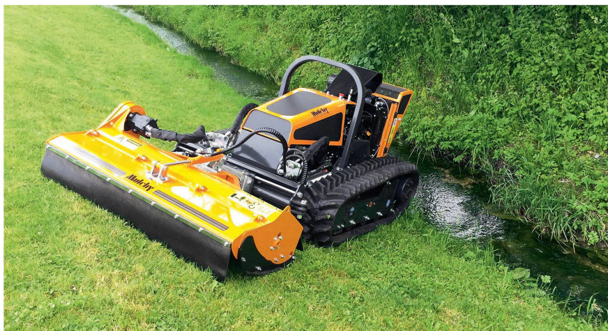
Ein Zukunftsmarkt für die Grünflächen- und Böschungspflege sind funkgesteuerte Mähraupen, vorzugsweise mit Akkuantrieb. Bild: zVg
