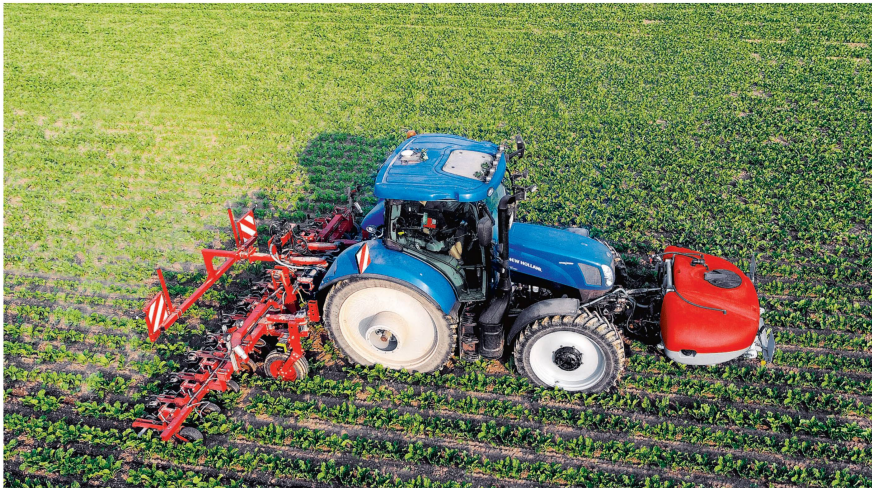
Den «EC-Weeder» gibt es nun auch in Kombination mit einem Fronttank zur kompakten Bandspritz-Möglichkeit.
