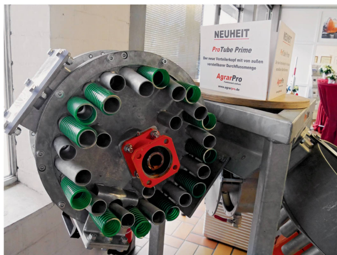
Die Verteilköpfe werden immer raffinierter, teilweise ist heute gar eine Schaltung von Einzelschläuchen analog «Section Control» möglich (Stapel, AgrarPro). Bild: R. Engeler
