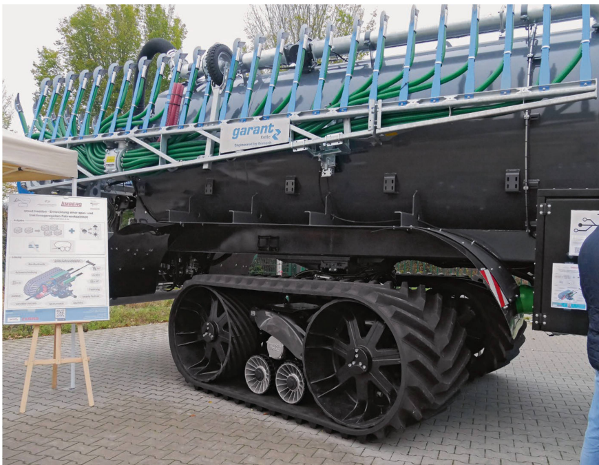
Raupenlaufwerke für Güllefässer: aktuell erst vereinzelt, an spezifischen Lösungen für die Gülleapplikation wird geforscht – beispielsweise Kotte in Kooperation mit der Hochschule Osnabrück. Bild: R. Engeler
