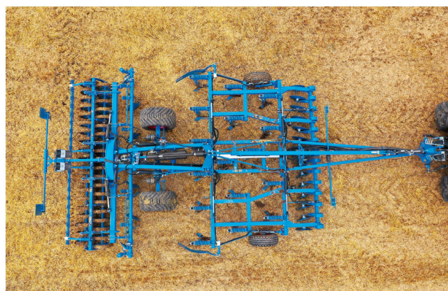
Beim dreibalkigen Grubber «Karat 10» sind die Zinken nun symmetrisch zur Zugachse angeordnet, wodurch sich die Maschine leichtzügiger präsentiert.
