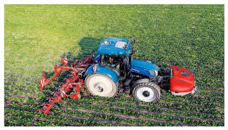
Den «EC-Weeder» gibt es nun auch in Kombination mit einem Fronttank zur kompakten Bandspritz-Möglichkeit.
