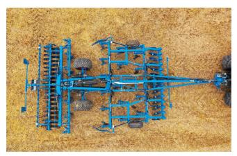
Beim dreibalkigen Grubber «Karat 10» sind die Zinken nun symmetrisch zur Zugachse angeordnet, wodurch sich die Maschine leichtzügiger präsentiert.
