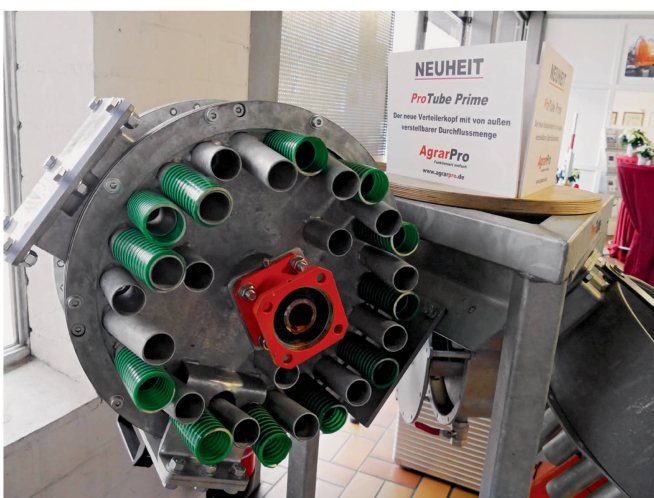
Die Verteilköpfe werden immer raffinierter, teilweise ist heute gar eine Schaltung von Einzelschläuchen analog «Section Control» möglich (Stapel, AgrarPro). Bild: R. Engeler
