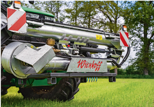
Alleinstellungsmerkmal von Wienhoff: Der quer klappbare und patentierte Saugrüssel «FreeSight». Bild: Wienhoff
