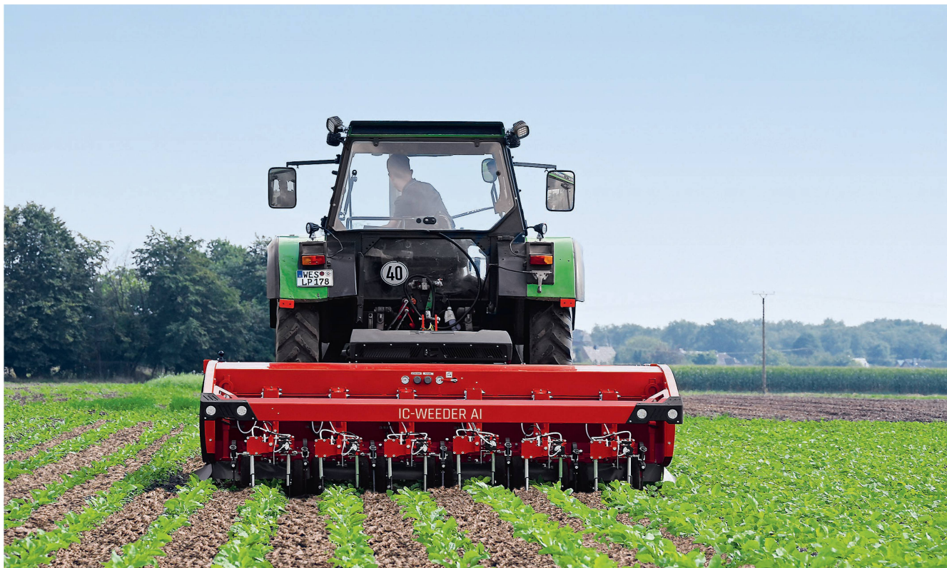
Hacktechnik wird noch wirkungsvoller, wenn Maschinen wie dieser «IC-Weeder» von Steketee dank künstlicher Intelligenz selbst zwischen Nutzpflanze und Unkraut unterscheiden und entsprechend gezielt arbeiten können. Bilder: Lemken
