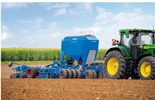
Neue Maschine mit neu angeordneter Bodenbearbeitung (Reifenpacker-Segmente) und bekannter Sätechnik: Die «Solitair DT» mit Doppeltank und Arbeitsbreiten von 4 und 6 m.
