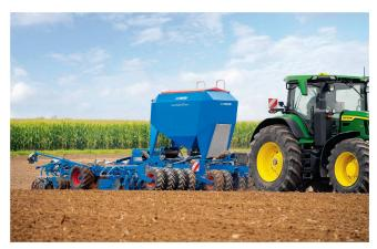
Neue Maschine mit neu angeordneter Bodenbearbeitung (Reifenpacker-Segmente) und bekannter Sätechnik: Die «Solitair DT» mit Doppeltank und Arbeitsbreiten von 4 und 6 m.
