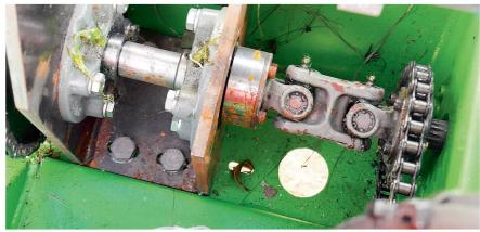
Der Antrieb erfolgt via Elektromotor über eine Kette (rechts), die beide Räder einer Fahrzeugseite bewegt. Zu sehen ist weiter das Doppelkardangelenk.
