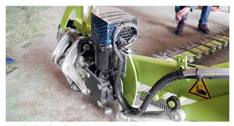
Das Mähwerk wird von diesem Elektromotor angetrieben.
