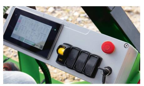
Blick auf das Bedienpult mit Bildschirm und den Knöpfen für die Mähwerkszuschaltung (gelb) und für die Beleuchtung.
