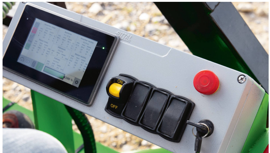
Blick auf das Bedienpult mit Bildschirm und den Knöpfen für die Mähwerkszuschaltung (gelb) und für die Beleuchtung.
