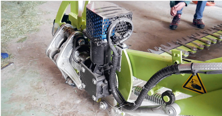
Das Mähwerk wird von diesem Elektromotor angetrieben.
