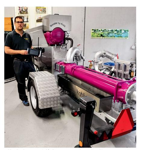
Kohlis Schneckenpumpen sind für härteste Beanspruchung gebaut, hier ausgestattet mit einem Booster der Marke Eigenbau zum Ausblasen der Verschlauchung mittels Luft.
