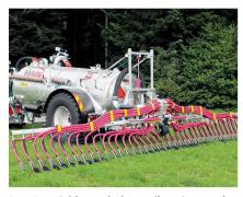
Den Fass-Schleppschuhverteiler «Starrpack» gibt's in Arbeitsbreiten von 7 und 9 m.
