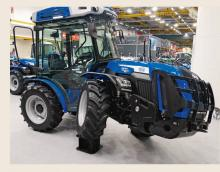
BCS «Dualsteer»: Kombination von Vorderrad- und Knicklenkung an einem Schmalspur-Traktor, so dass der Wenderadius massiv verkürzt wird.
