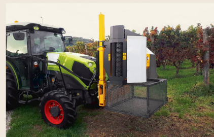
«ALS 2020» von Spezia ist ein Frontanbaugerät für Weinbau-Traktoren, das die roten Blätter der Rebe, die einen pharmazeutischen Wert haben, selbsttätig detektiert, einsammelt und direkt in einen Behälter legt.
