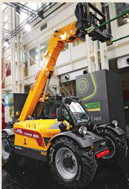
Der Teleskoplader «GD 42.7» von Dieci verfügt über eine adaptive Lasterkennung von Walvoil. Das Load-Sensing-Hydrauliksystem wird dynamisch entsprechend der Last angepasst, was den Kraftstoffverbrauch reduziert und die Motorleistung besser ausnützt.
