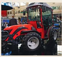
Spezialtraktor Antonio Carraro «SRX Tora»: Trotz Umstellung auf die Abgasnorm der Stufe 5 und mit Integration eines Partikelfilters konnten die ursprünglichen Dimensionen beibehalten werden, so dass man weiterhin enge Räume befahren kann.
