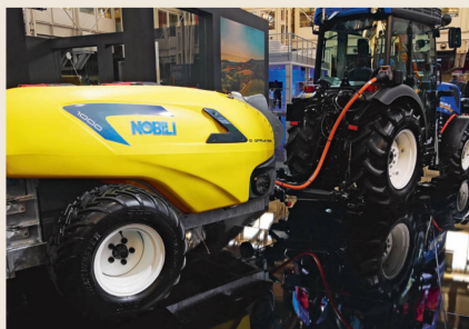
Nobili und CNH bekamen die Auszeichnung für elektrisch angetriebene Geräte wie Obstspritzen und Mulcher, angebaut an einem Schmalspurtraktor, der an der Front einen von der Zapfwelle angetriebenen Stromgenerator mitführt.
