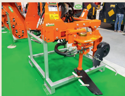
Selvatici und Bertoni erhielten den Award für einen rotierenden Untergrundlockerer mit Werkzeugen, die sich auf einer elliptischen Bahn bewegen und so die Bodenstruktur weniger zerstören. Darüber hinaus soll Treibstoff gespart werden.
