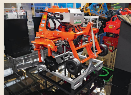
«Easyride» von Rinieri: Automatisches Fahrsystem, das den Abstand zur Baumreihe misst und eingreift, indem es die Position des Stockräumers mithilfe des Hydraulikzylinders für den Seitenverschieb automatisch korrigiert.
