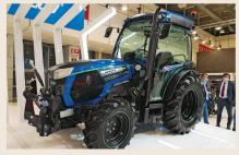
Hybridelektrischer Traktor Landini «Rex 4»: Konzept eines hybridelektrischen Traktors mit automatischem Getriebe, bei dem die Vorderachse elektrisch angetrieben wird und das Antriebsverhältnis zwischen Vorder- und Hinterachse den Bedürfnissen angepasst werden kann, so dass der Wendekreis kleiner wird. Zusätzlich gibt es eine elektrisch gesteuerte, semiaktive Kabinenfederung.
