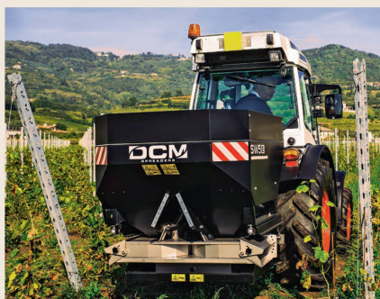
Zweischeiben-Düngerstreuer «SWS E» von DCM: Es können unterschiedliche Düngermengen links und rechts appliziert werden.
