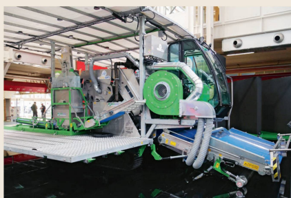
«Slide Ventum Trax» von Hortech kann kleinblättriges Gemüse ernten. Dieses wird über einen Luftstrom direkt in Kisten geführt, so dass Verunreinigungen laufend weggeblasen werden. Zudem werden die Kisten permanent gewogen, um so eine gleichmässige Befüllung zu erreichen.
