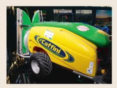
Caffini «Smart Synthesis»: Gebläse mit elektrisch angetriebenem Lüfter, zusätzliche Verfügbarkeit einer mittelsparenden Pulsweiten-Modulation.
