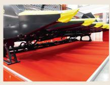
Schneidwerk Olimac «Drago Gold»: Für die Sonnenblumenernte konzipiert, umfasst das Schneidwerk einen hydraulisch angetriebenen Häcksler für die Stängel und verfügt über eine hydraulische Einrichtung für die unterschiedliche Schnitthöhe von Stängel und Blütenkopf.
