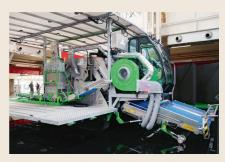
«Slide Ventum Trax» von Hortech kann kleinblättriges Gemüse ernten. Dieses wird über einen Luftstrom direkt in Kisten geführt, so dass Verunreinigungen laufend weggeblasen werden. Zudem werden die Kisten permanent gewogen, um so eine gleichmässige Befüllung zu erreichen.
