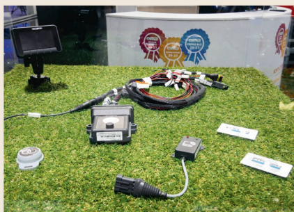
Cobo mit den Kits «Agri 4.0» und «Easy Fit»: Damit können Anbaugeräte am Traktor mit digitalen Methoden erkannt werden, deren Funktionen und Arbeiten aufgezeichnet werden können.
