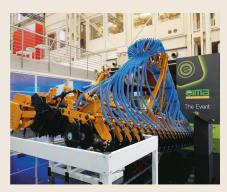
Verteilkopf Alpego «Horizon»: Ein elektromechanischer, horizontal selbst nivellierender Verteilkopf für pneumatische Sämaschinen, so dass auch in Hanglagen stets eine gleichmässige Verteilung des Saatguts gewährleistet ist.
