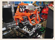
«Easyride» von Rinieri: Automatisches Fahrsystem, das den Abstand zur Baumreihe misst und eingreift, indem es die Position des Stockräumers mithilfe des Hydraulikzylinders für den Seitenverschub automatisch korrigiert.
