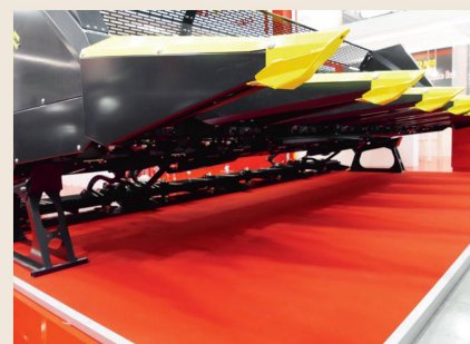
Schneidwerk Olmac «Drago Gold»: Für die Sonnenblumenenernte konzipiert, umfasst das Schneidwerk einen hydraulisch angetriebenen Häcksler für die Stängel und verfügt über eine hydraulische Einrichtung für die unterschiedliche Schnitthöhe von Stängel und Blütenkopf.
