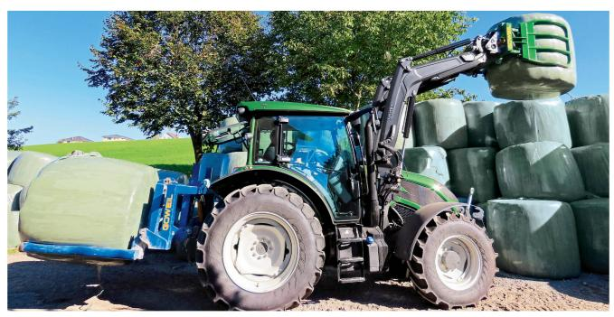
Der Valtra «A115 Hitech-4» ist kompakt gebaut, bewährte Technik wurde mit neuer ergänzt, so dass sich der Traktor noch vielseitiger einsetzen lässt, wie beim Transport von Siloballen auf dem Hofgelände. Bilder: M. Abderhalden
