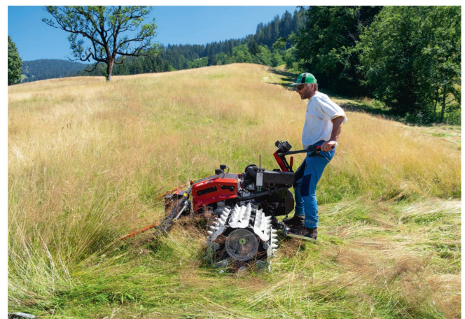
Das Trittbrett eignet sich für das Mitfahren auf Hanglagen bis etwa 40% Neigung.
