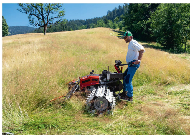
Das Trittbrett eignet sich für das Mitfahren auf Hanglagen bis etwa 40% Neigung.
