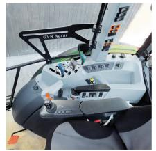
Der in der Armlehne integrierte Proportional-Joystick für Frontlader oder FH ist verstellbar und lässt sich sehr feinfühlig bedienen.
