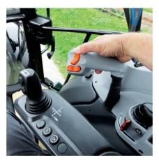
Über diese beiden Taster werden Gänge und Lastschaltstufen angewählt. Das «Hitech-4»-Getriebe bietet vier Gänge und vier Lastschaltstufen, Letztere mit Automatik.
