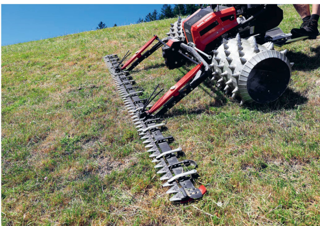
Speziell am «KDSP»-Balken ist, dass der Mähbalken links und rechts über den Rahmen hinausragt.
