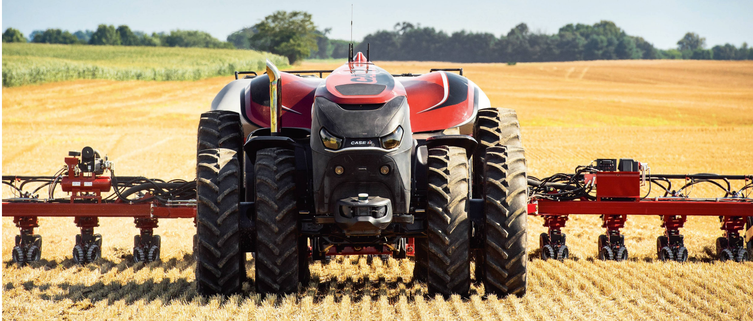
Vor fünf Jahren präsentierte Case IH erstmals sein autonomes Konzept mit kabinenlosem Traktor, der mit einer Vielzahl von Anbaugeräten eingesetzt werden kann. Bild: Case IH
