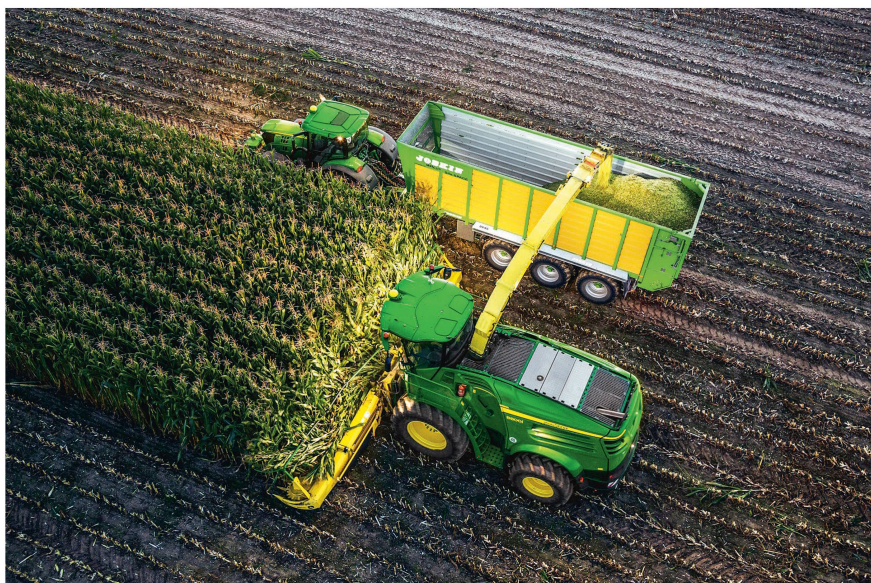
Mit «Machine Sync» von John Deere kann ein Mähdrescher oder Feldhäcksler während des Abtankens oder Überladens den nebenherfahrenden Traktor steuern. Damit werden die Fahrer beim permanenten Überladen deutlich entlastet und Schäden an den Maschinen vermieden. Bild: John Deere
