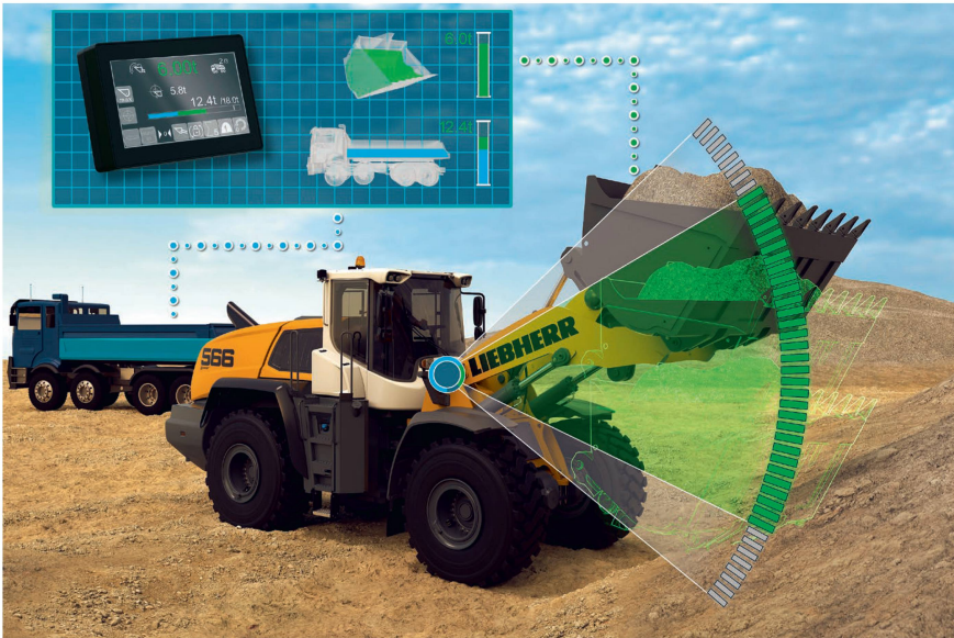
Bei der Wiegeeinrichtung «Truck Payload Assist» von Liebherr passt sich der Wiegebereich automatisch an die Einsatzbedürfnisse an. Bild: Liebherr
