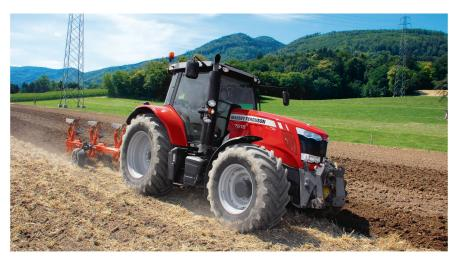
Ein richtig eingestellter Pflug bringt schnell mal 10 bis 20 Prozent Einsparung. Auch ein tiefer Reifendruck senkt bei Ackerarbeiten den Diesel-Verbrauch.
