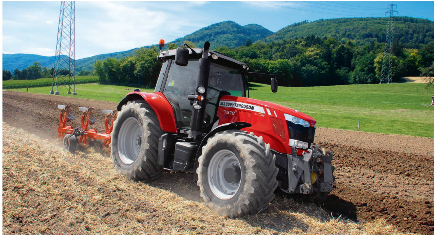
Ein richtig eingestellter Pflug bringt schnell mal 10 bis 20 Prozent Einsparung. Auch ein tiefer Reifendruck senkt bei Ackerarbeiten den Diesel-Verbrauch.
