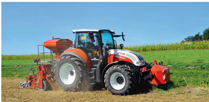
Arbeitstiefe, Gewicht und Intensität der Bodenbearbeitung sind wichtige Einflussfaktoren für den Dieserverbrauch.
