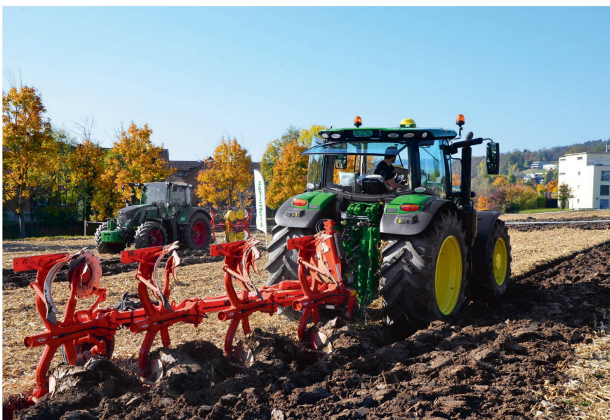
Das Pflügen erfordert viel Zugkraft, denn jeder Zentimeter Tiefe bewegt 150 Tonnen Erdmaterial pro Hektar. Bild: R. Hunger
