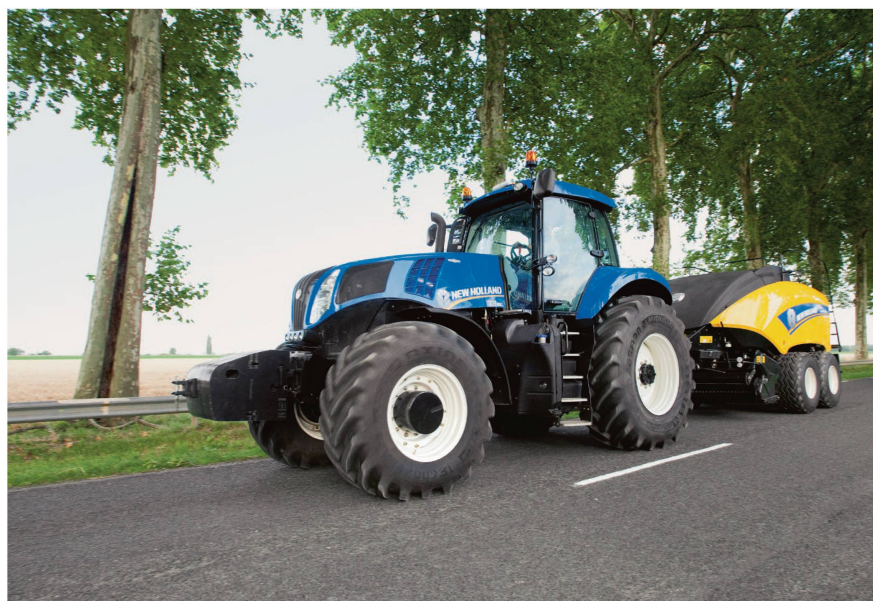
Auf der Strasse ist alles anders: Mit Ackerluftdruck (0,5 bar) kann der Dieselverbrauch gegenüber Strassenluftdruck (1,6 bar) auf 120 Prozent ansteigen. Bild: CNH
