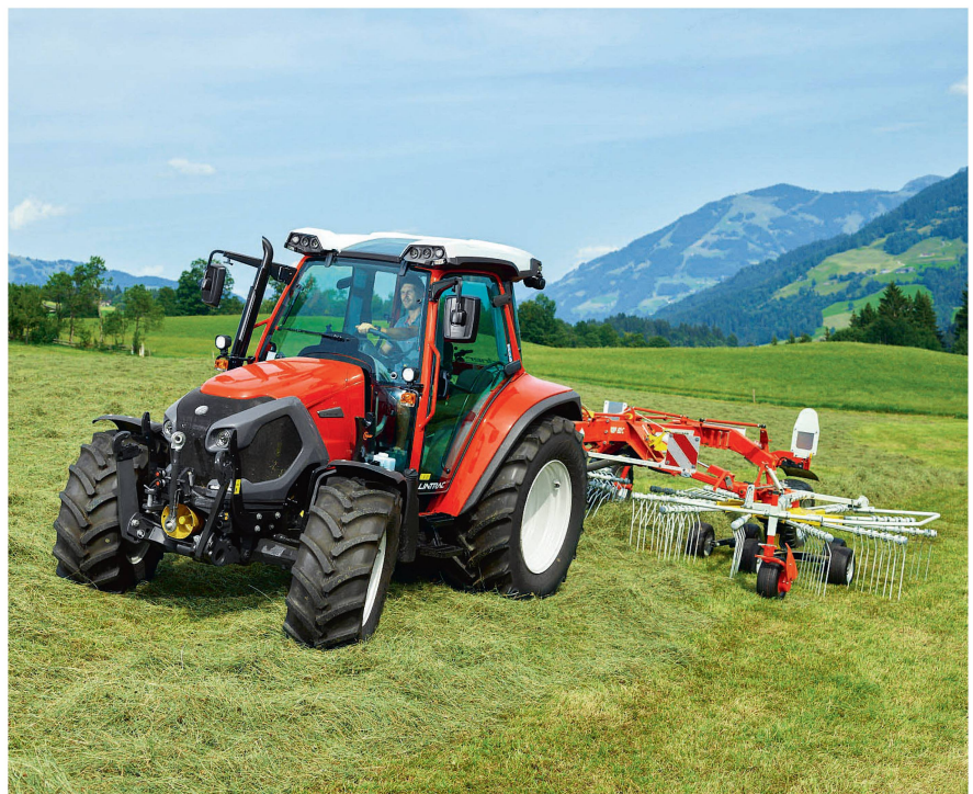
Die Zapfwellendrehzahl ist so zu wählen, dass der Traktor im verbrauchsgünstigen Bereich läuft. Bild: Lindner
