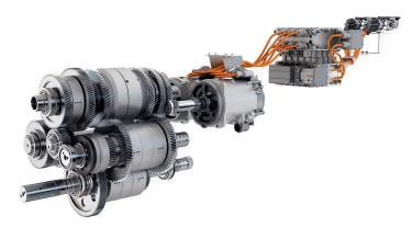
«eAutoPowr»-Getriebe mit elektrisch-mechanischer Leistungsverzweigung und der Möglichkeit, über Wechselrichter und Steckdosen bis 100 kW elektrische Leistung an externe «Verbraucher» abzugeben. Bild: John Deere
