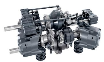
«VarioDrive»-Getriebe mit Verzweigungsplanetengetriebe (Bildmitte oben), Hydropumpe (links unten), Hydromotor 1 für Hinterachse (links oben, leicht verdeckt), Hydromotor 2 mit Lamellenkupplung für Vorderachse (rechts unten) und Lamellenkupplung als Längsdifferenzialsperre (Bildmitte unten, leicht verdeckt). Bild: Fendt
