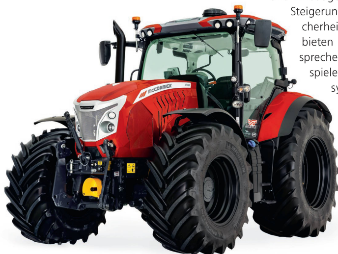
McCormick «X7.618» als Vertreter der neuen 6-Zylinder-Modelle mit kurzem Radstand. Für die Kabinenfederung stehen eine mechanische und eine semiaktive hydropneumatische Variante zur Verfügung. Im Gegensatz zu den grösseren «X7.6»-Modellen wird hier kein Guss-Halbrahmen verbaut. Bild: McCormick
