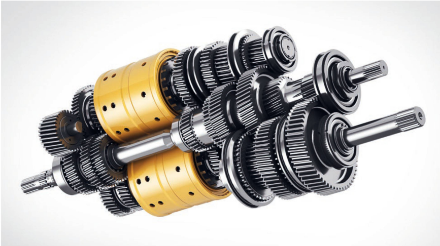
8-fach-Lastschaltgetriebe mit Doppelkupplungstechnik von CNH: Mit nur zwei Lamellenkupplungen können acht Lastschaltstufen geschaltet werden. Bild: CNH
