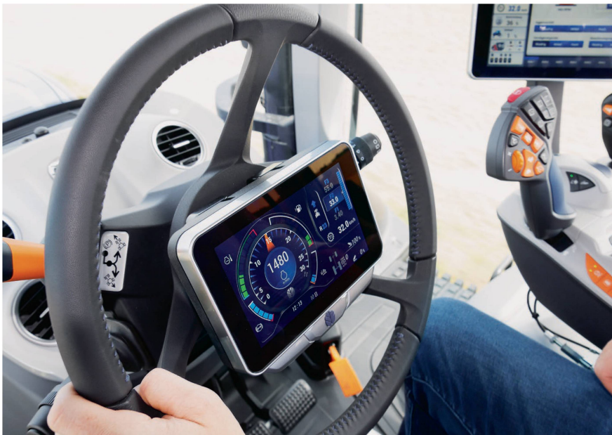
Feststehendes Display im Lenkrad bei den Modellen «T7 HD» von New Holland. Bild: R. Engeler
