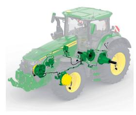
John Deere bietet für die Baureihe «8R» neu eine integrierte Reifendruckverstellanlage an. Bild: John Deere
