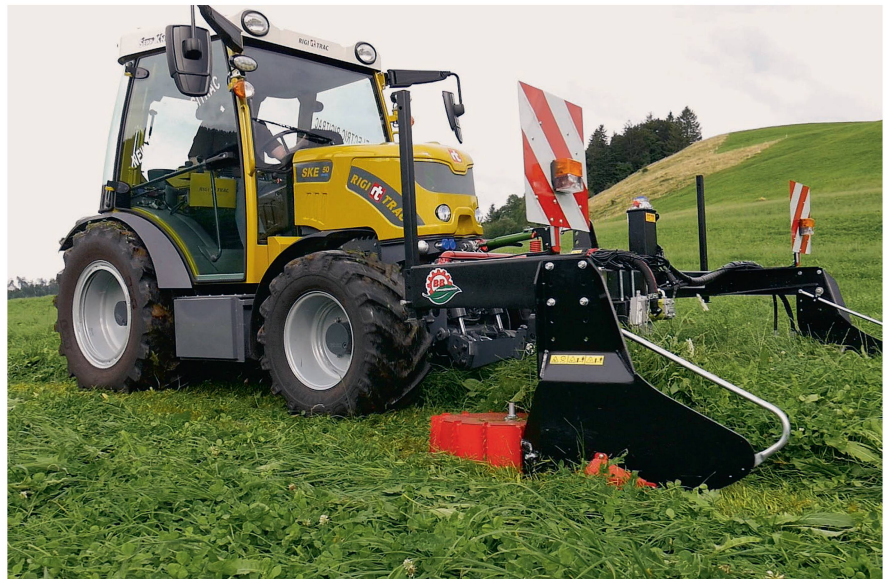
Mit batterieelektrischen Traktoren lassen sich die Vorteile der Elektrifizierung konsequent nutzen (im Bild ein Prototyp des Rigitrac «SKE50 Electric»). Bild: R. Engeler
