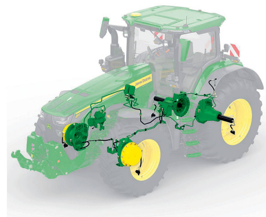
John Deere bietet für die Baureihe «8R» neu eine integrierte Reifendruckverstellanlage an. Bild: John Deere
