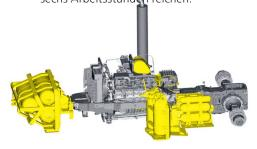
Anordnung der CNG-Tanks beim New Holland «T6.180 Methane Power»: Integrierte Standard-Druckbehälter auf der linken und rechten Seite, zusätzliche Druckbehälter an der Traktorfront. Bild: New Holland
