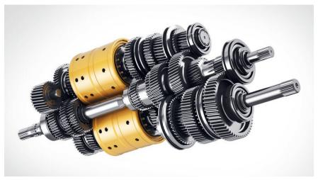
8-fach-Lastschaltgetriebe mit Doppelkupplungstechnik von CNH: Mit nur zwei Lamellenkupplungen können acht Lastschaltstufen geschaltet werden. Bild: CNH
