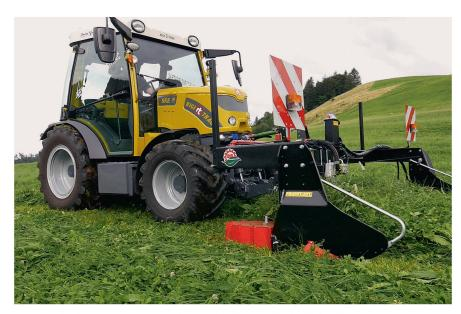
Mit batterieelektrischen Traktoren lassen sich die Vorteile der Elektrifizierung konsequent nutzen (im Bild ein Prototyp des Rigitrac «SKE50 Electric»). Bild: R. Engeler
