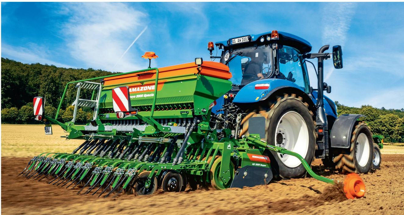
Die Sämaschine «Cataya Special» lässt sich nun optional auch mit Doppelscheibenscharen vom Typ «TwinTec» bestücken. Bilder: Amazone
