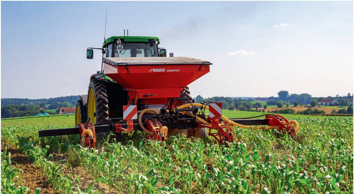
Die neue «Deepot»-Tiefendepotdüngung aus dem Hause Rauch mit Hecktank und vier Injektionsscharen an der Scharschiene. Bilder: Rauch
