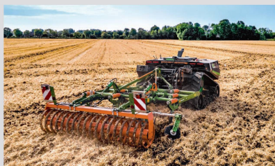
156 PS der Zugmaschine «AgBot» ziehen einen 3-balkigen Anbaugrubber vom Typ «Cenio» über ein Stoppelfeld.
