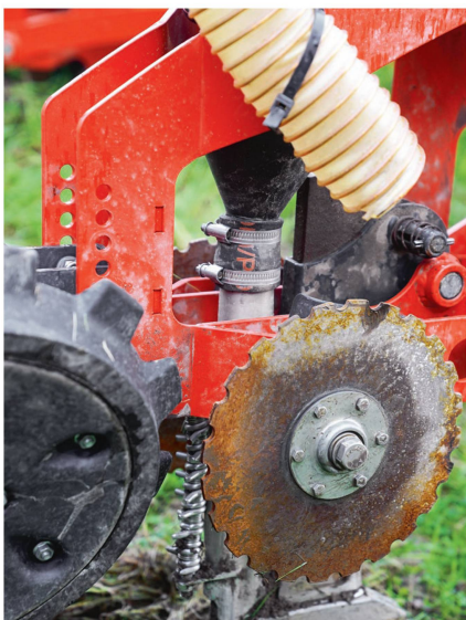
Eine Injektionsschar mit (von links) Andruckrollen, den (zur Patentierung angemeldeten) Kratzfedern, dem Düngekanal mit «Zyklon» obendrauf und dem «Torpedo» (die vorauslaufende Sechsscheibe ist vom rostbehafteten Leitblechrad verdeckt).
