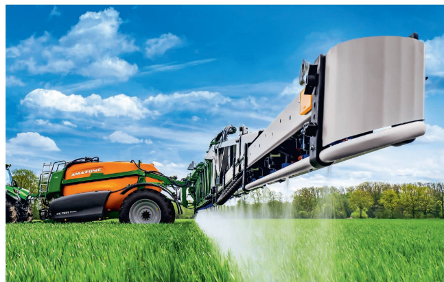
Die Feldspritze «UX 7601 Super» weist einen einteiligen Rahmen ohne separate Deichsel auf. Der Schwerpunkt liegt niedrig.
