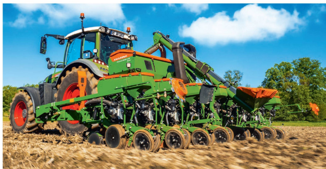
Um gleichmässige Feldaufgänge zu erzielen, führt Amazone mit «SmartForce» eine automatische Schardruckverstellung bei der Einzelkornsämaschine «Precea» ein. Die Einzelreihen samt Düngerschar lassen sich zudem auf Wunsch um bis zu 40 cm verschieben, um Fahrgassen anzulegen.
