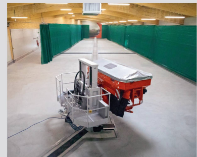
Blick in Europas modernste Düngestreuer-Testhalle; der Streuer ist auf einem Drehschemel befestigt.
