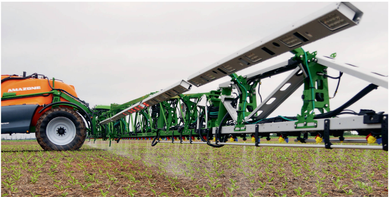
Die zielgerichtete Sprühtechnik «Smart Spraying» von Bosch und BASF ermöglicht, Unkraut auf noch nicht aufgelaufenen Parzellen zu bekämpfen (green on brown) sowie punktuelle Behandlungen in Kulturen (green on green). Bild: M. Schubnel
