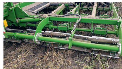
Um die Maschinenkosten durch vorherige Überfahrten zu reduzieren, gibt es neu die Option einer vorlaufenden Messerwalze für die Säkombination «Cirrus».
