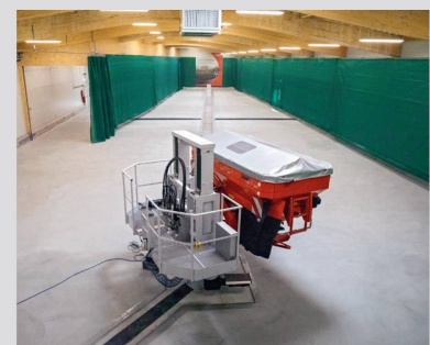
Blick in Europas modernste Düngestreuer-Testhalle; der Streuer ist auf einem Drehschemel befestigt.
