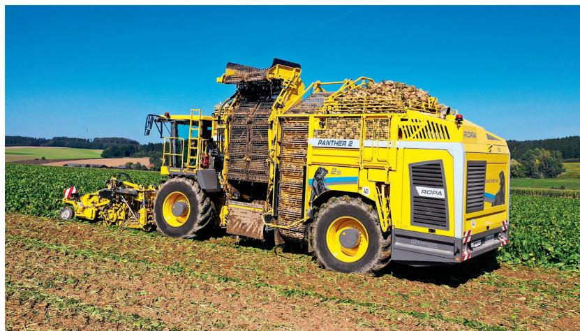
Im neuen «Panther 2S» vereint Hersteller Ropa sportlich-modernes Design mit Wendigkeit und Agilität für effizientes Rübenroden. Ausgestattet ist die Maschine mit einem 796 PS starken Volvo-Penta-Reihenmotor mit einem maximalen Drehmoment von 3650 Nm und 16,12 l Hubraum. Integriert ins Maschinendesign ist auch das medaillen-prämierte und bodenschonende Fahrwerkssystem mit Wankstabilisierung und automatischem Hangausgleich. Wie im
