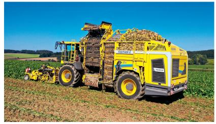
Im neuen «Panther 2S» vereint Hersteller Ropa sportlich-modernes Design mit Wendigkeit und Agilität für effizientes Rübenroden. Ausgestattet ist die Maschine mit einem 796 PS starken Volvo-Penta-Reihenmotor mit einem maximalen Drehmoment von 3650 Nm und 16,12 l Hubraum. Integriert ins Maschinendesign ist auch das medaillenprämierte und bodenschonende Fahrwerksystem mit Wankstabilisierung und automatischem Hangausgleich. Wie im
