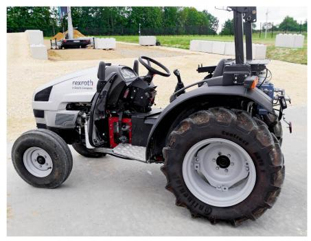
Mit «eOC» zeigte Bosch Rexroth einen neuen Fahrantrieb, der die elektronische Ansteuerung von Hydraulikpumpen in einem offenen Kreislauf (und in nur einem Kreislauf) ermöglicht.
