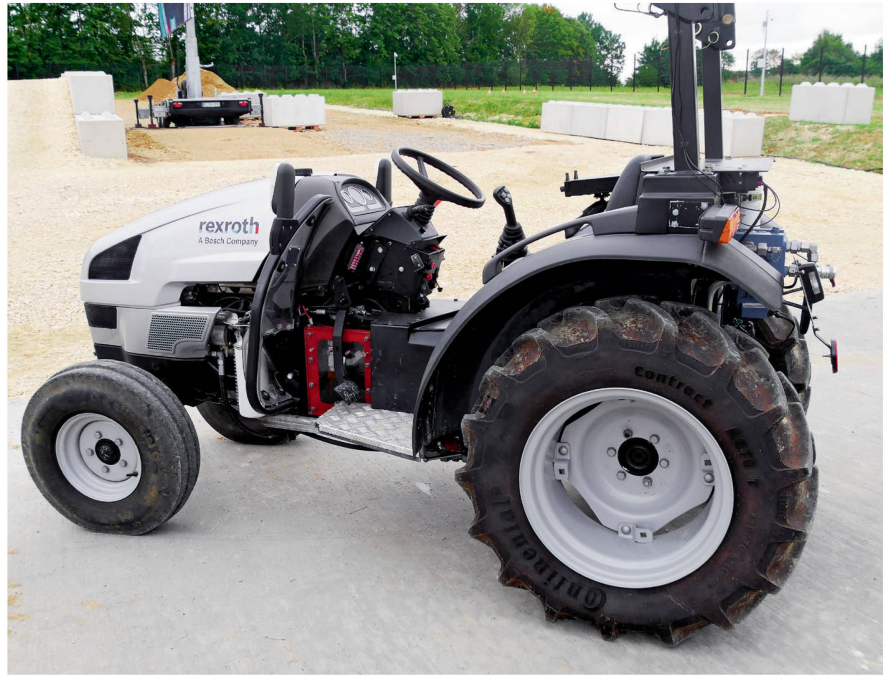
Mit «eOC» zeigte Bosch Rexroth einen neuen Fahrtrieb, der die elektronische Ansteuerung von Hydraulikpumpen in einem offenen Kreislauf (und in nur einem Kreislauf) ermöglicht.
