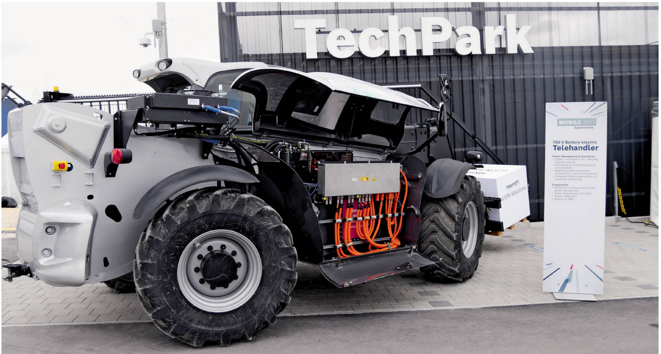
Rexroth bietet ab 2022 elektrifizierte Komplett-Lösungen für Arbeitsmaschinen an. Dieser 11-Tonnen-Teleskoplader ist mit Elektro-Motoren und weiteren E-Komponenten aus der neuen «eLion»-Linie von Bosch Rexroth bestückt. Bilder: H. Röthlisberger
