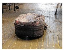
Der Kot wird durch den Mistroboter «Discovery Collector» aufgesammelt und in separate Lager abgeworfen.
